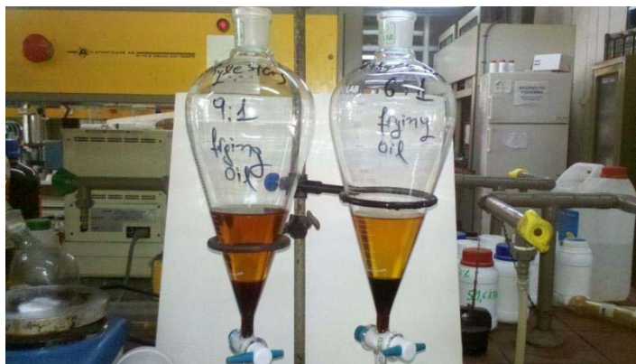
Εικόνα 3-2: Ο διαχωρισμός των φάσεων γλυκερίνης και εστέρα.
