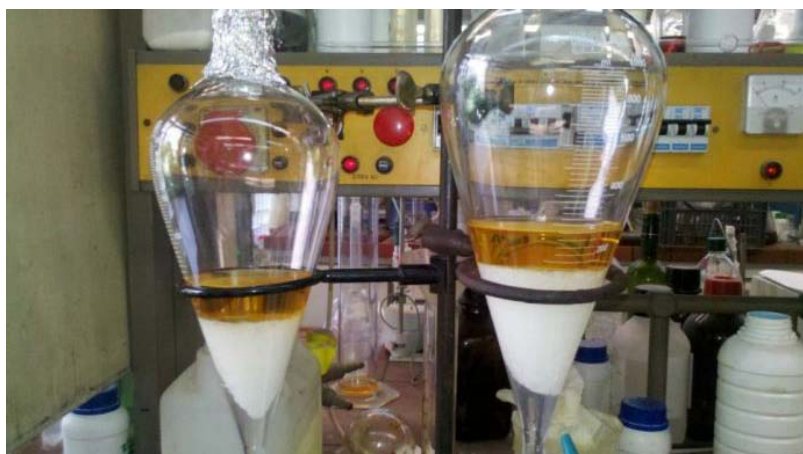
Εικόνα 3-3: Σχηματισμός γαλακτωμάτων κατά τις εκπλύσεις.
