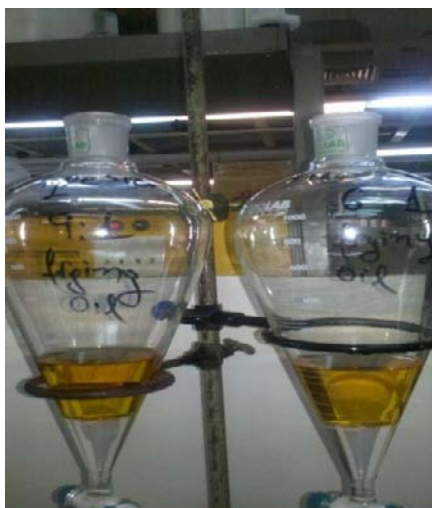
Εικόνα 3-4: Βιοντίζελ διαυγές με νερό.
