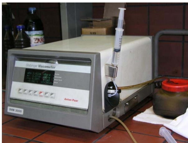
Εικόνα 3-5: Ιξωδόμετρο Stabinger SVM 3000
