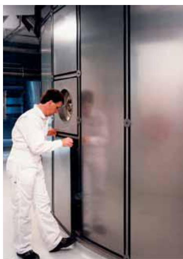
Εικόνα 1.3 Αφαιρούμενα μονωτικά πάνελ για θαλάμους ξήρανσης ψεκασμού
