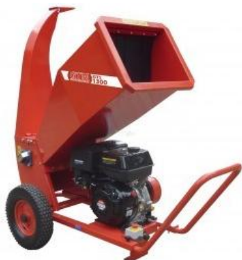
Εικόνα 5-4: Θρυμματιστής GTS 1300 ισχύος 13HP ολλανδικής εταιρείας DE WILD, πηγή: http://www.kidonakis.com/item.php?itid=1049
