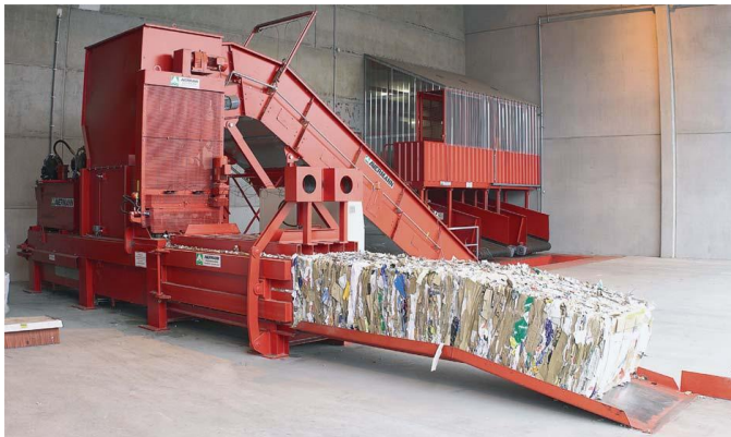
Εικόνα 5-3: Δεματοποιητής εταιρείας AVERMANN (Οριζόντιος δεματοποιητής AVOS 1410), πηγή www.alphagreen.gr
