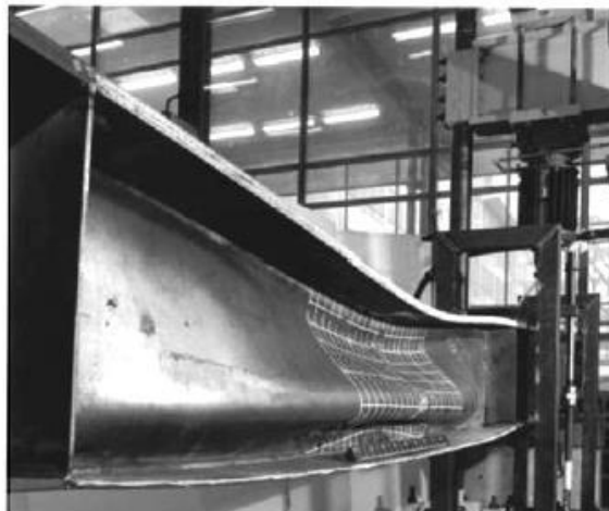
Σχήμα 1.15 Τοπικός λυγισμός κορμού.
