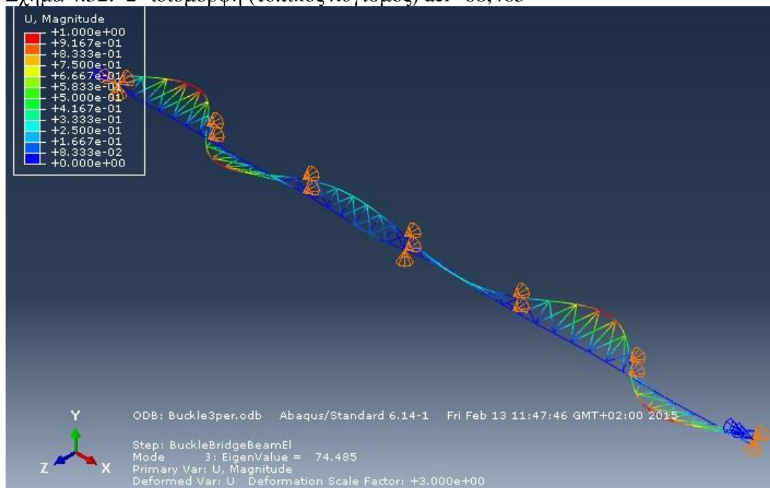
Σχήμα 4.33: 3 η ιδιομορφή (πλευρικός λυγισμός) \text{acr}=74,485
