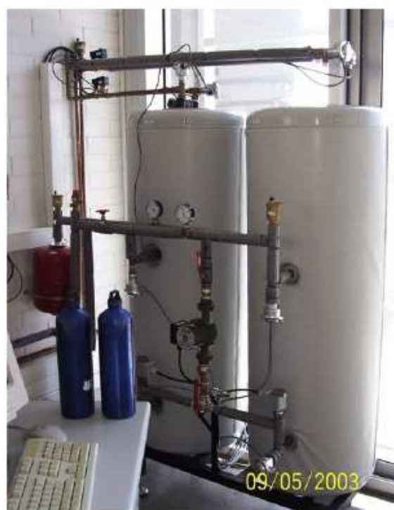
Εικόνα 26: Δεξαμενή θερμού νερού χρήσης για οικία με ΥΑΦ για την εκτέλεση του πειράματος.
