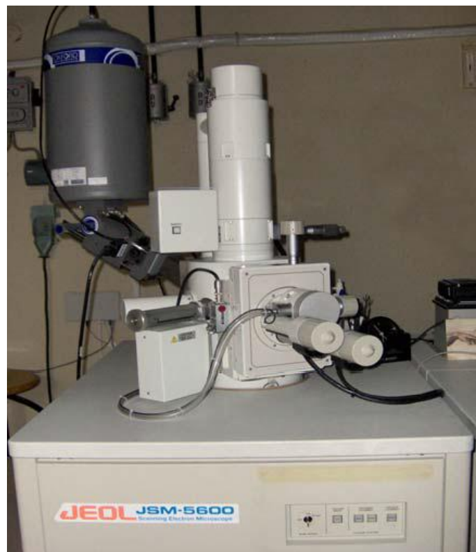
Σχήμα 9.3 Σαρωτικό ηλεκτρονικό μικροσκόπιο–μικροαναλυτής με φασματόμετρο διασποράς των ενεργειών των ακτίνων-Χ (SEM-EDS)
