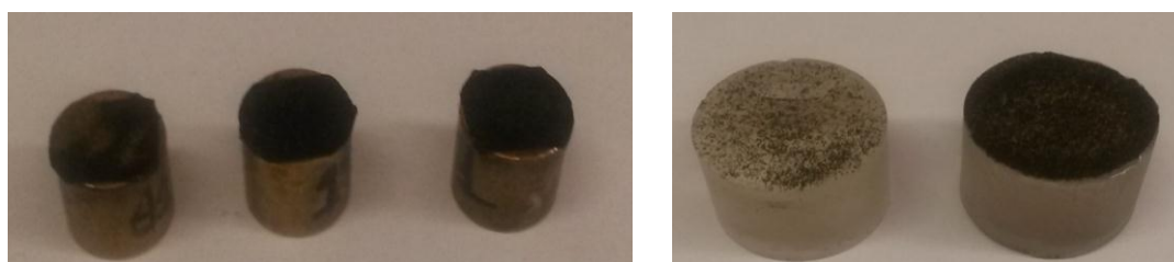
Σχήμα 5.10 (α) δειγματοφορείς SEM, (β) Δείγμα εγκιβωτισμένο σε ρητίνη
