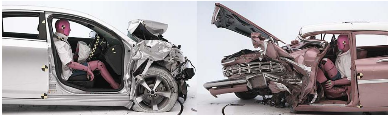
Εικόνα 1.3: Τα δύο αυτοκίνητα της Chevrolet (Bel Air και Malibu) έπειτα από τη μετωπική σύγκρουσή τους
