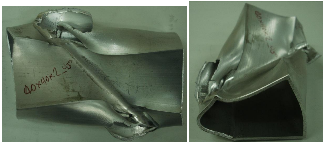
Πειραματικό δοκίμιο μετά την ολοκλήρωση της κατάρρευσης
