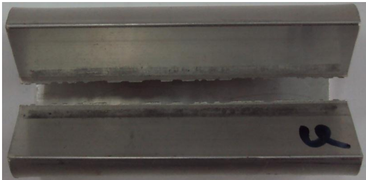
Πειραματικό δοκίμιο μετά την ολοκλήρωση της κατάρρευσης
