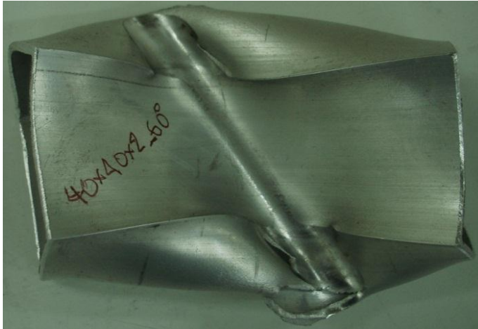
Πειραματικό δοκίμιο μετά την ολοκλήρωση της κατάρρευσης
