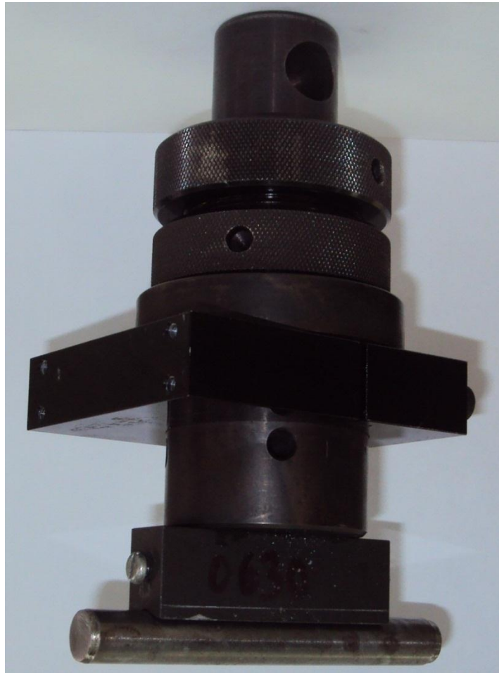
Εικόνα 1.8: Η σφήνα στήριξης του κυλινδρικού διεισδυτή προσαρμοσμένη στο έμβολο της πρέσας
