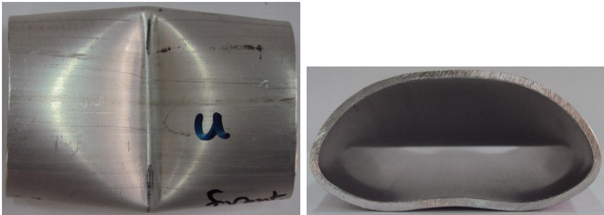
Πειραματικό δοκίμιο μετά την ολοκλήρωση της κατάρρευσης
