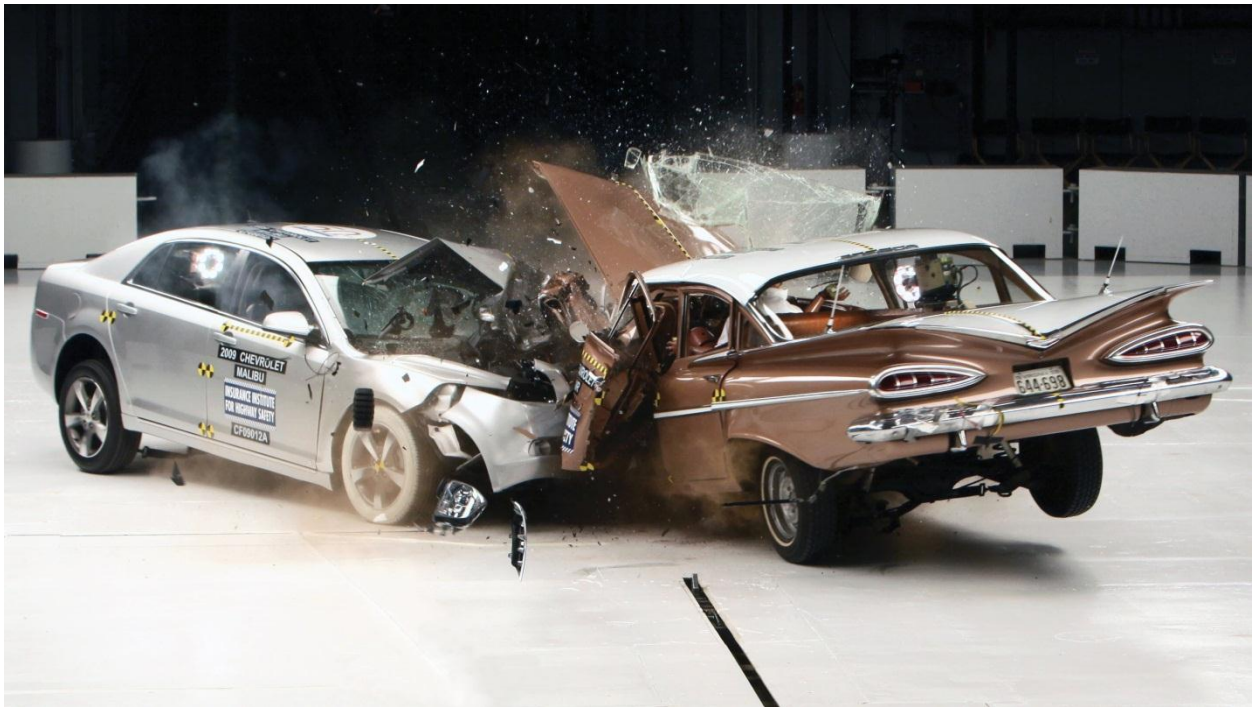
Εικόνα 1.2: Τα δύο αυτοκίνητα της Chevrolet (Bel Air και Malibu) κατά τη διάρκεια της μετωπικής σύγκρουσής τους
