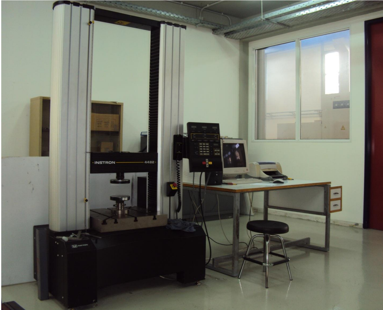
Εικόνα 1.7: Ο πειραματικός εξοπλισμός που χρησιμοποιήθηκε. Η φωτογραφία πάρθηκε στο ισόγειο του Τομέα των Κατεργασιών. Στην περίπτωσή μας η άνω πλάκα είχε αντικατασταθεί από το σύστημα εμβόλου πρέσας- βάσης στήριξης διεισδυτή – κυλινδρικού διεισδυτή που παρουσιάζεται στη συνέχεια στην εικόνα 1.8.
