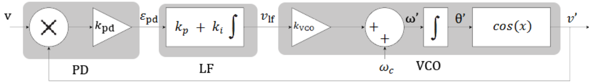
Σχήμα 2.2 : Διάγραμμα ενός στοιχειώδους PLL
