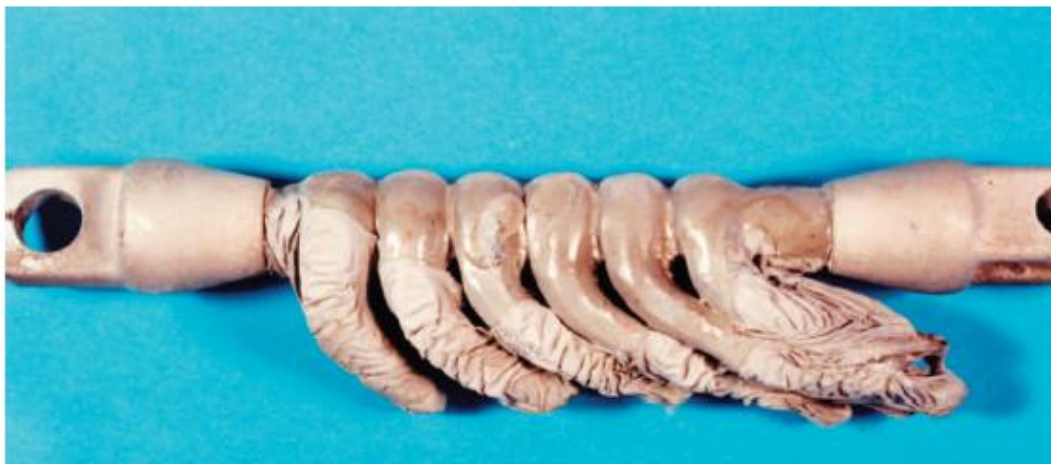
Σχήμα 1-3: Υδρόλυση του περιβλήματος εποξειδικής ρητίνης στο μονωτήρα GEPOL [12]
