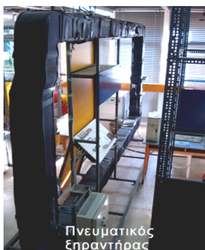
Εικόνα 13. Πνευματικός ξηραντήρας (προβιομηχανικής κλίμακας του εργαστηρίου Σχεδιασμού και Ανάλυσης Διεργασιών
