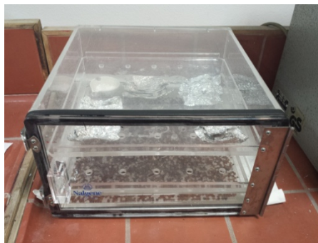
Εικόνα 3.30 Ξηραντήρας με ειδικά διαμορφωμένο αφυγραντήριο
