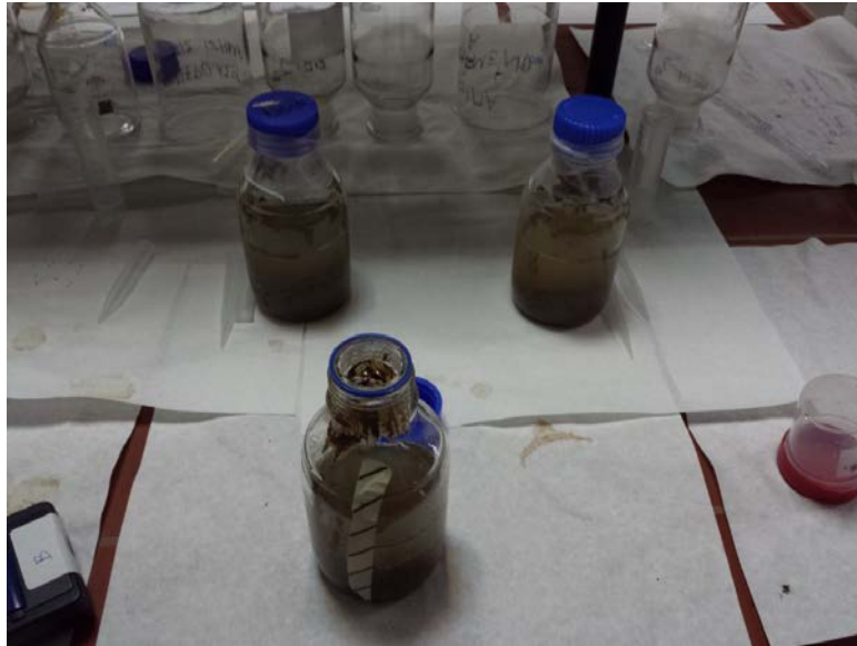
Εικόνα 3.18 Αερόβια-αποστειρωμένα συστήματα κατά την εκτέλεση του πειράματος
