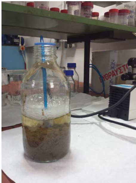
Εικόνα 3.19 Αερισμός συστήματος με διαχύτη
