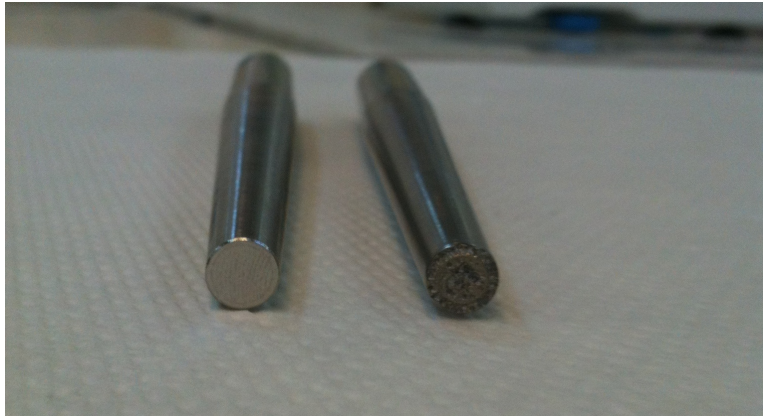
Εικόνα 2.7: Καινούριο ηχόδιο (αριστερά) και ηχόδιο μετά από περίπου 15 ώρες χρήσης (δεξιά).
