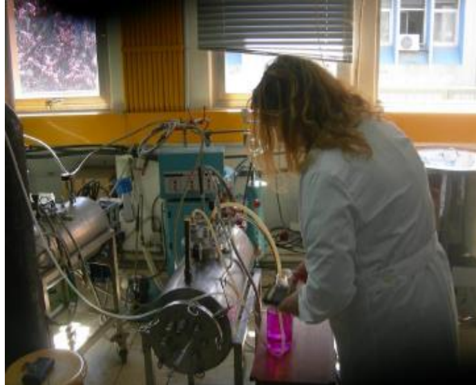
Εικόνα 21:Βιοαντιδραστήρας 20L.στο εργαστήριο βιοτεχνολογίας του Ε.Μ.Π.
