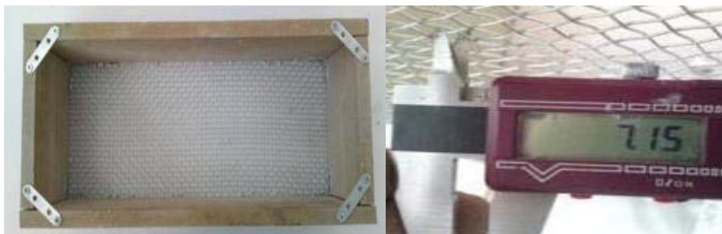
Άποψη του κόσκινου για τον διαχωρισμό των σκύρων.
