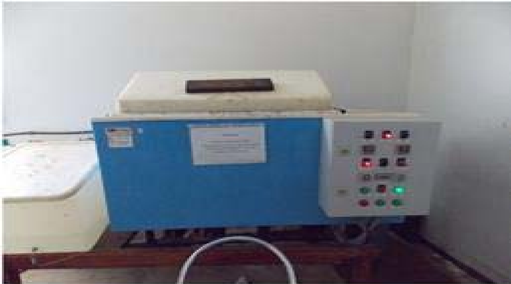
ΕΙΚ. 5.11 ΣΥΣΚΕΥΗ ΕΠΙΤΑΧΥΝΟΜΕΝΗΣ ΔΙΑΒΡΩΣΗΣ (ΑΛΑΤΟΝΕΦΩΣΗ), ΑΡΙΣΤΕΡΑ ΔΙΑΚΡΙΝΟΥΜΕ ΤΟ ΔΟΧΕΙΟ ΤΟΠΟΘΕΤΗΣΗΣ ΑΛΑΤΟΝΕΡΟΥ(ΑΣΠΡΟ ΔΟΧΕΙΟ), ΣΤΟ ΚΕΝΤΡΟ ΦΑΙΝΕΤΑΙ Ο ΚΑΔΟΣ ΤΟΠΟΘΕΤΗΣΗΣ ΔΟΚΙΜΙΩΝ (ΓΑΛΑΖΙΟΣ ΚΑΔΟΣ) ΚΑΙ ΔΕΞΙΑ Ο ΠΙΝΑΚΑΣ ΕΛΕΓΧΟΥ ΤΗΣ ΣΥΣΚΕΥΗΣ.
