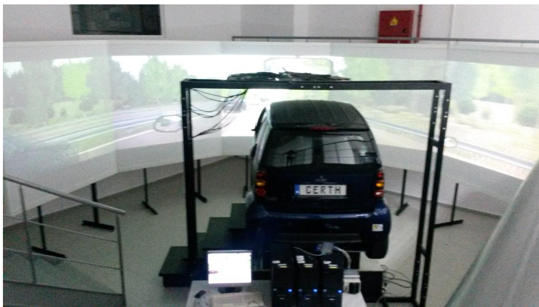
Εικόνα 45: Ο προσομοιωτής οδήγησης που χρησιμοποιήθηκε στο πείραμα
