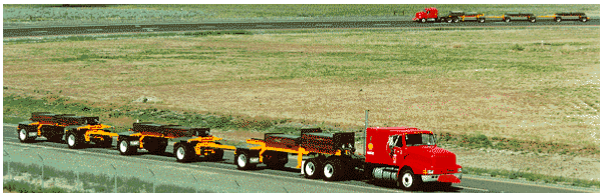
Εικόνα 25: Αυτοματοποιημένα οχήματα WesTrack στο Nevada Automotive Test Center
