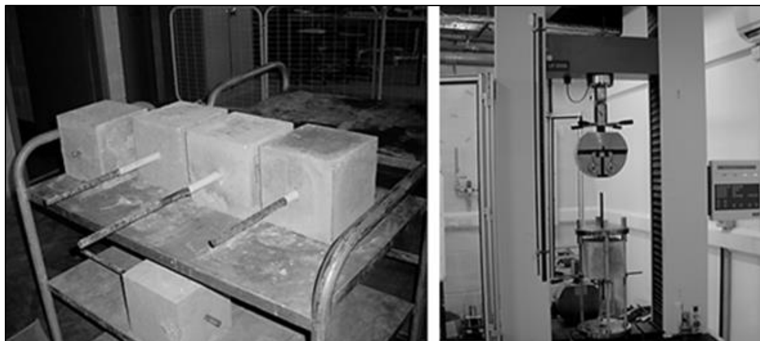
Σχήμα 10.69: Κυβικά δοκίμια για τη δοκιμή εξόλκευσης (αριστερά) και δοκιμή pull-out (δεξιά) στις 28 ημέρες μετά από συντήρηση
