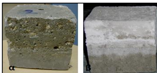
Σχήμα 10.20: δοκίμια με 10% EMDW (α) και αναφοράς (β) έπειτα από 130 ημέρες μερικής εμβάπτισης σε Na 2 SO 4 5% κ.β.
