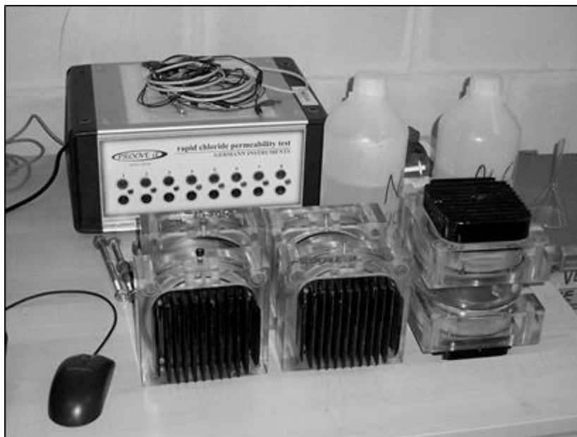
Σχήμα 4.6: Πειραματική διάταξη της επιταχυνόμενης διείσδυσης Cl^- κατά ASTM C-1202
