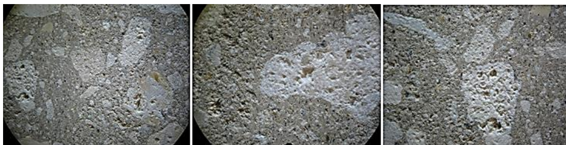
Σχήμα 10.54: κυλινδρικά δοκίμια σκυροδέματος με 5% EMDW μετά από κοπή σε τροχό στις 130 ημέρες εμβάπτισης σε NaCl 3,5% κ.β
