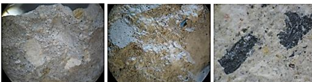
Σχήμα 12.26: Δοκίμια σκυροδέματος με 10% καλαμίνα στις 130 ημέρες εμβάπτισης σε NaCl 3,5% κ.β
