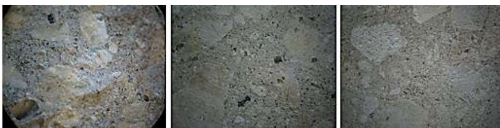
Σχήμα 12.25: Δοκίμια σκυροδέματος με 5% καλαμίνα στις 130 ημέρες εμβάπτισης σε NaCl 3,5% κ.β
