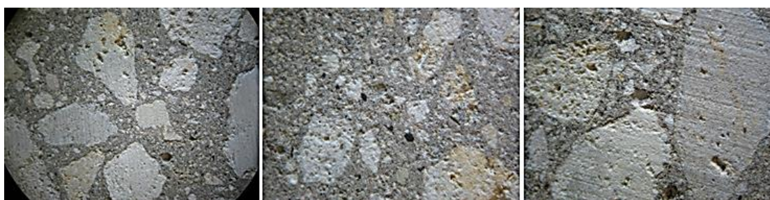
Σχήμα 10.56: Μορφολογία σκυροδέματος με 10% EMDW στις 130 ημέρες εμβάπτισης σε \text{Na}_2\text{SO}_4 5% κ.β
