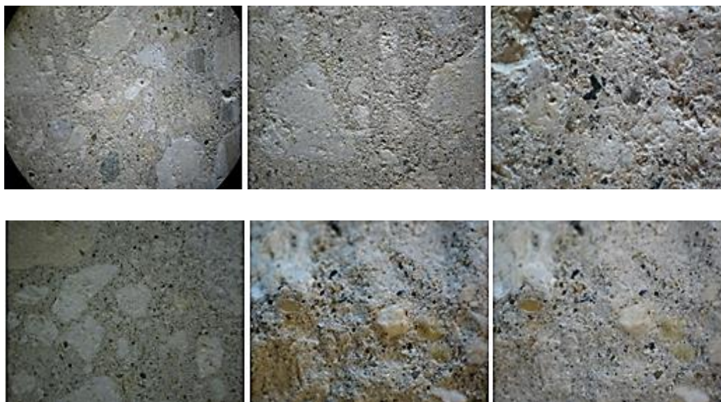
Σχήμα 11.45: Δοκίμια σκυροδέματος με 10% FAPT μετά από κοπή σε τροχό στις 130 ημέρες εμβάπτισης σε NaCl 3,5% κ.θ
