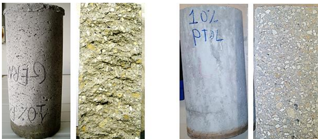
Σχήμα 11.16: Δοκίμια σκυροδέματος και τομές με Ι.Τ Γερμανίας (αριστερά) και Ι.Τ Πτολεμαΐδας (δεξιά).
