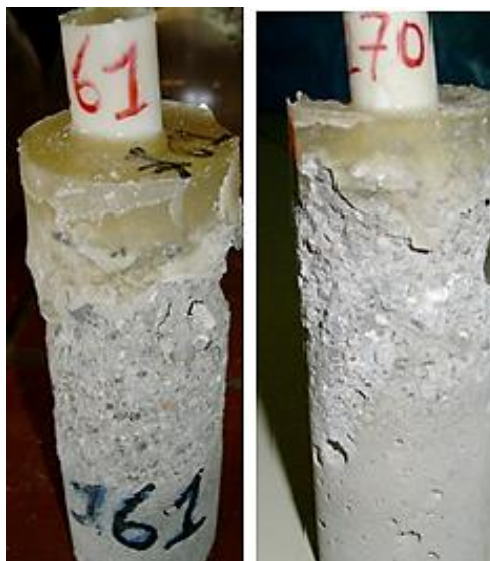
Σχήμα 10.47: οπλισμένα δοκίμια τσιμεντοκονίας με 5% EMDW (αριστερά) και 10% EMDW (δεξιά) μετά από 24 μήνες εμφύπτισης σε \text{Na}_2\text{SO}_4 5% κ.β.
