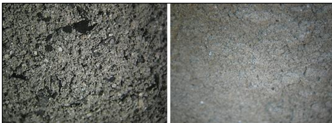
Σχήμα 6.2: Στερεοσκοπική παρατήρηση x8 της κοκκομετρίας δυο ειδών Ι.Τ (η φωτογραφία απεικονίζει Ι.Τ που χρησιμοποιήθηκαν στην παρούσα Διατριβή)
