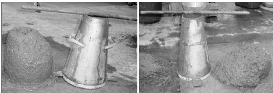
Σχήμα 6.3: Δοκιμή κάθισης σε σκυρόδεμα με 100%ΟΡC (δεξιά) και 90%ΟΡC+10%F.A (αριστερά) με λογό W/C=0.65. (η εικόνα αφορά πειραματά της παρούσας Διδακτορικής Διατριβής)
