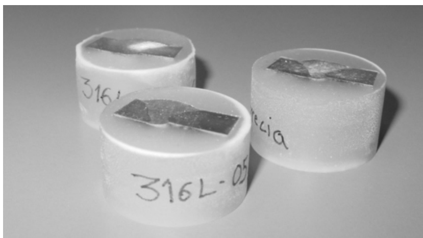
Εικόνα1.18 : Τομές της συγκόλλησης εγκιβωτισμένες σε ρητίνη και στίλβωμένες. Διακρίνεται το μέταλλο συγκόλλησης καθώς έχει προηγηθεί χημική προσβολή.
