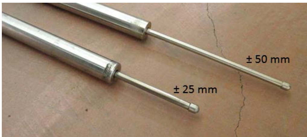
Εικόνα 1.4 :Τα LVDTs που χρησιμοποιήθηκαν κατά την διεξαγωγή των πειραμάτων.
