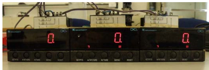
Εικόνα 1.13 : Αναлого-ψηφιακός μετατροπέας που χρησιμοποιήθηκε για τον προσδιορισμό των παραμενουσών τάσεων.
