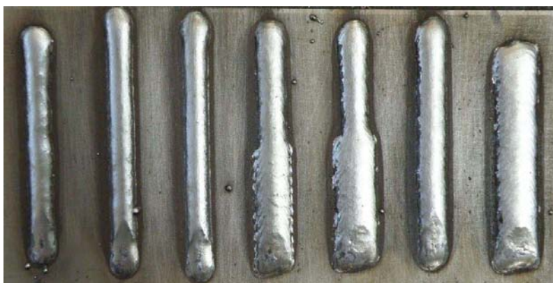
Εικόνα 1.14 : Δοκιμές συγκόλλησης (bead on plate)
