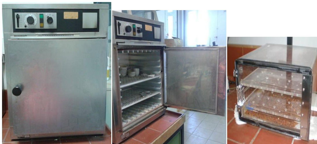
Εικόνα 3.8 : Αριστερά εικονίζεται ο φούρνος των 103 °C, και δεξιά ο ξηραντήρας
