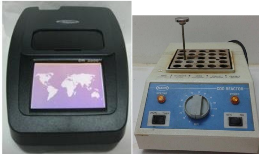
Εικόνα 3.10 : Αριστερά εικονίζεται το φασματοφωτόμετρο τύπου HACH DR2800 και δεξιά ο χωνευτής για φιαλίδια COD
