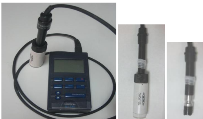
Εικόνα 3.5 : Συσκευή μέτρησης DO μοντέλο Oxi 3301 της WTW
