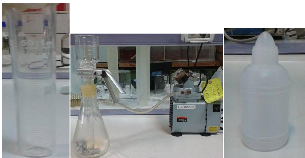
Εικόνα 3.15 : Αριστερά εικονίζεται ο ογκομετρικός σωλήνας 50 mL, στη μέση η γυάλινη μονή συσκευή διήθησης με χρήση αντλίας κενού και δεξιά το πλαστικό μπουκαλάκι
