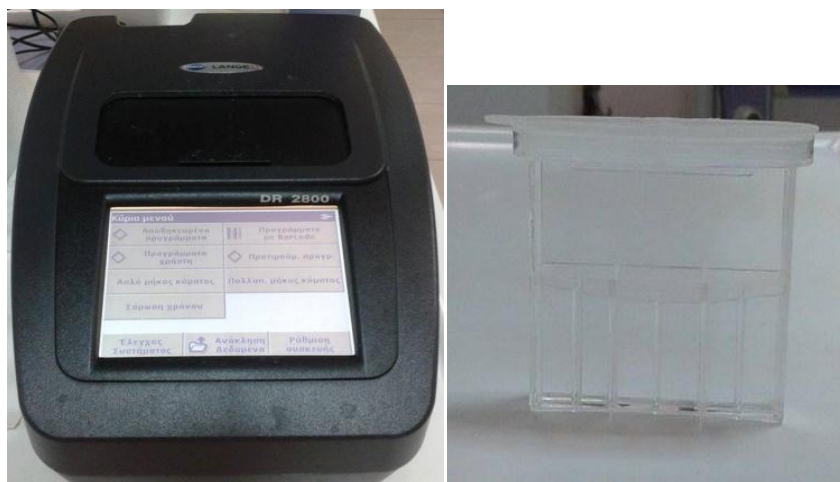
Εικόνα 3.14 : Αριστερά εικονίζεται το φασματοφωτόμετρο τύπου HACH LANGE DR 2800 και δεξιά η ειδική κυψελίδα
