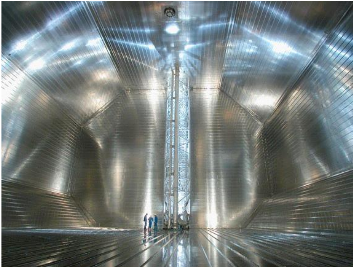
Εικόνα 2.4:4 Εσωτερικό δεξαμενής LNG Carrier (Πηγή: gcaptain)
