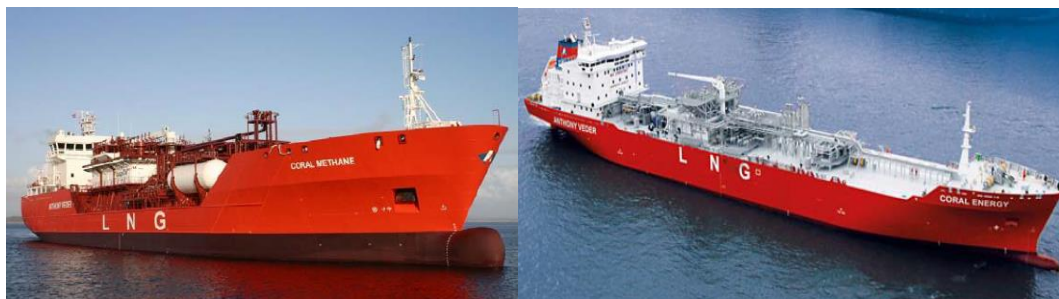
Εικόνα 1.5:6 "CORAL METHANE" & "CORAL ENERGY" with Type C Tanks
