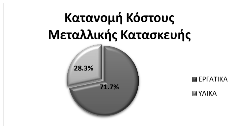
Διάγραμμα 6:1 Κόστος Μεταλλικής Κατασκευής
