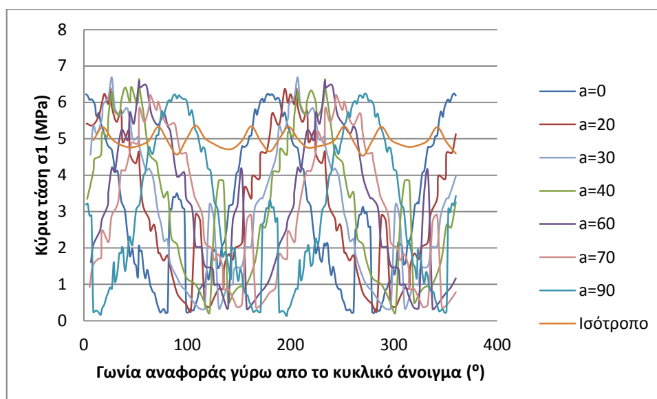
Σχήμα 4.2: Μεταβολή της κύριας τάσης \sigma_1 συναρτήσει της μεταβολής της κλίσης των ασυνεχειών, γύρω από το κυκλικό άνοιγμα.
