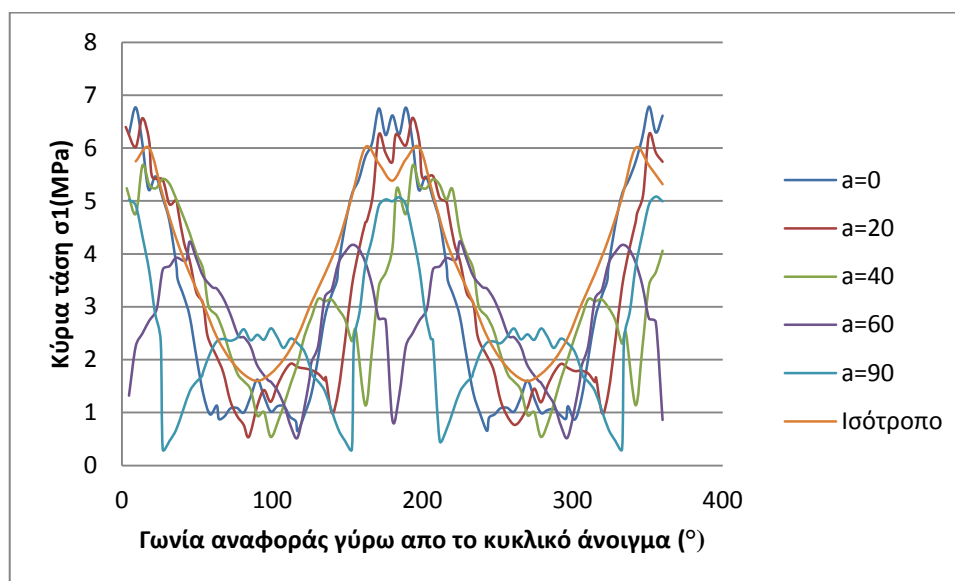
Σχήμα 4.16: Μεταβολή της κύριας τάσης \sigma_1 συναρτήσει της μεταβολής της κλίσης των ασυνεχειών, γύρω από το κυκλικό άνοιγμα.
