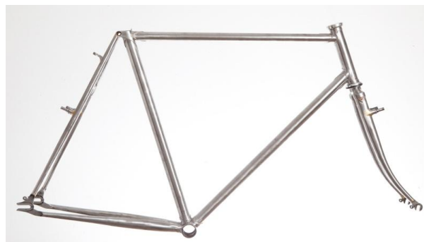
Σχήμα 2.3.1. Πλαίσιο ποδηλάτου από χάλυβα
