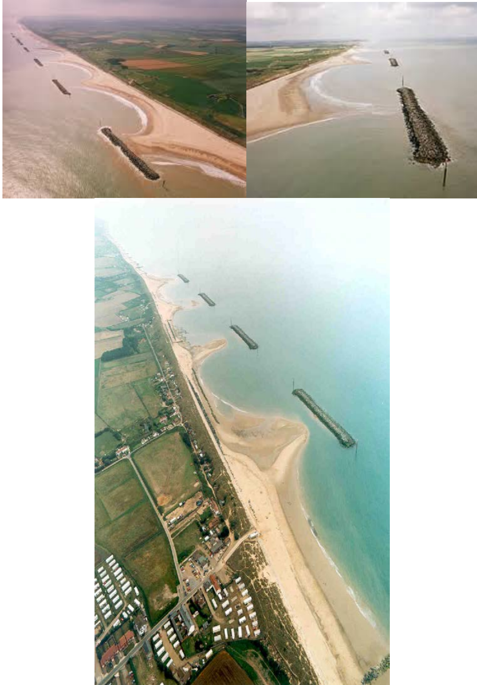
Εικόνα 3.2 Χαρακτηριστικοί σχηματισμοί salient και tombolo πίσω από κυματοθραύστες στο Sea Palling του Norfolk της Μ. Βρετανίας ( www.southwestcoastalgroup.org , www.hydrosurveys.co.uk , www6.plymouth.ac.uk )
