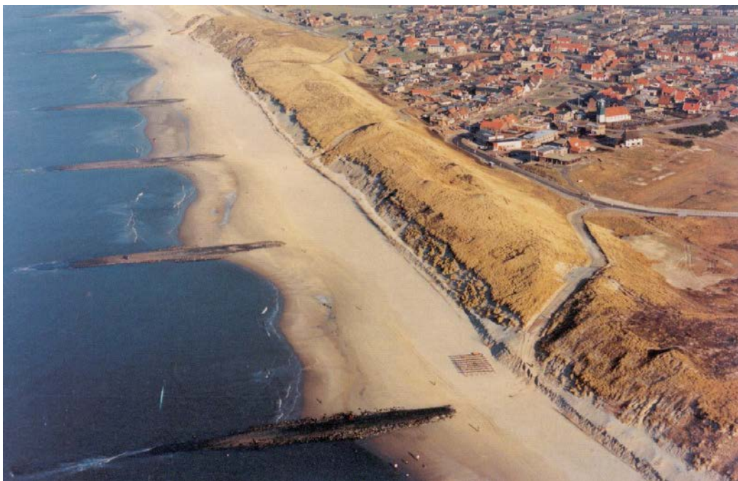
Εικόνα 3.4 Σύστημα διαδοχικών προβόλων για τη διατήρηση επαρκούς πλάτους σε ακτή της Ολλανδίας ( www.kennisbank-waterbouw.nl )
