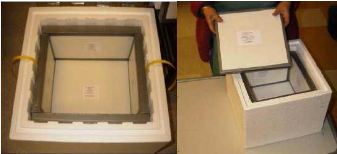
Εικόνα 9.8.4.1 Πλάκες με PCM για ενίσχυση των δοχείων μεταφοράς ευαίσθητων προϊόντων [84]
