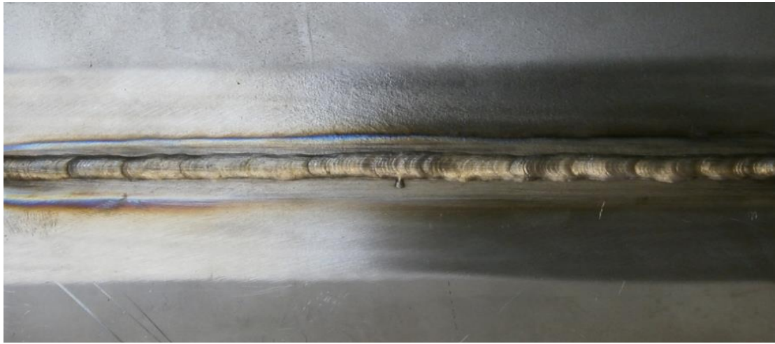
Εικόνα 10 Συγκόλληση με την μέθοδο TIG
