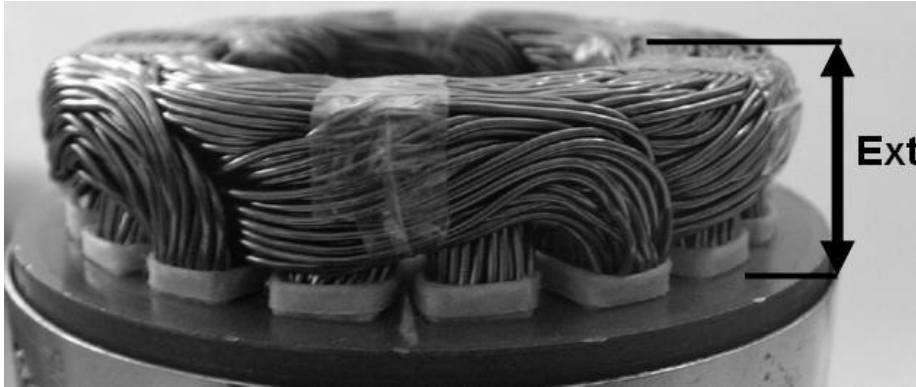
Σχήμα 1.15: Άκρα διανεμημένου τυλίγματος.[9]
