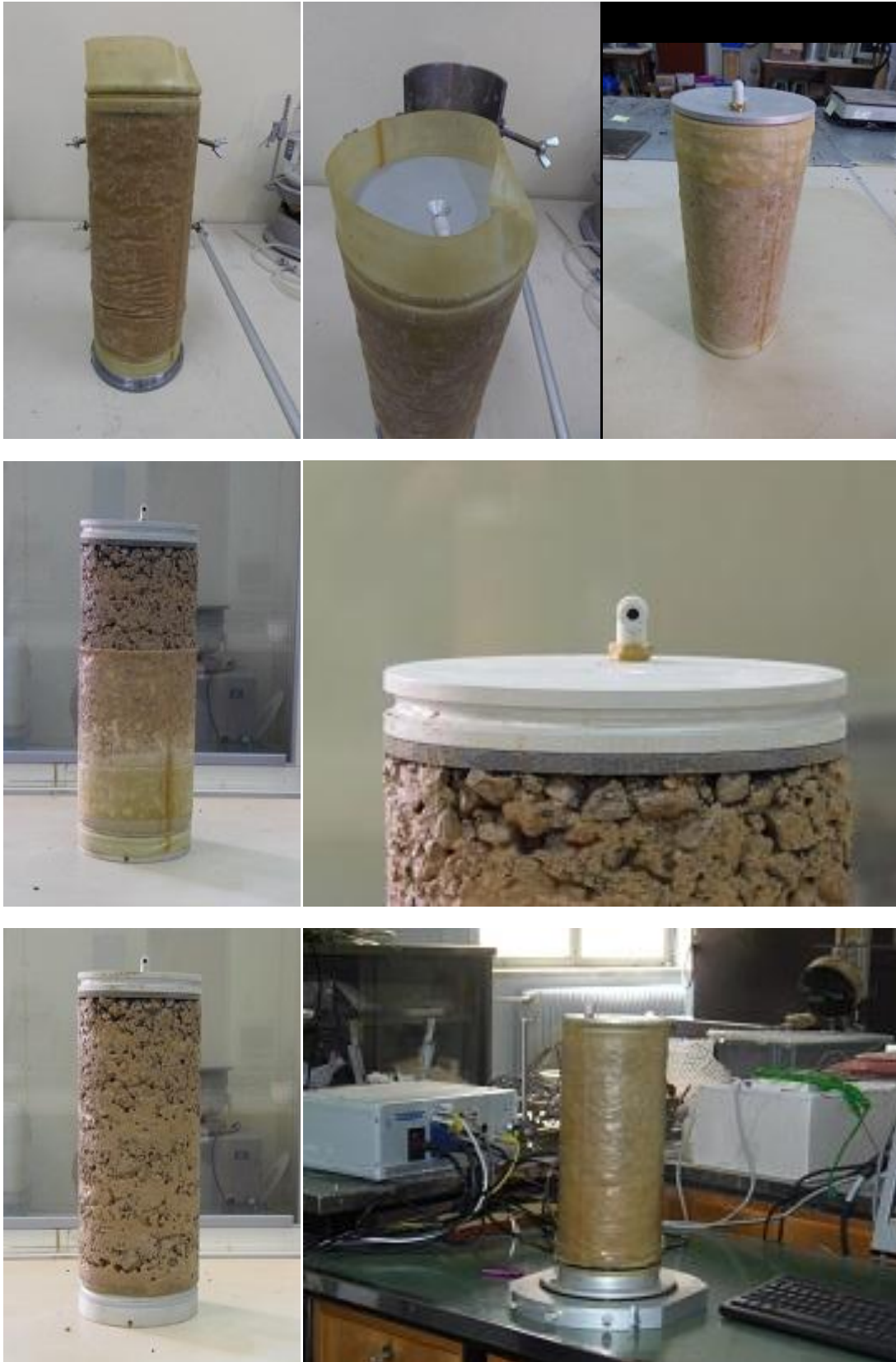
ΦΩΤΟΓΡΑΦΙΑ 10: Αφαίρεση του δοκιμίου από τη μήτρα, μορφή δοκιμίου χωρίς την μεμβράνη και τοποθέτηση δοκιμίου στη βάση του τριαξονικού κελιού.
