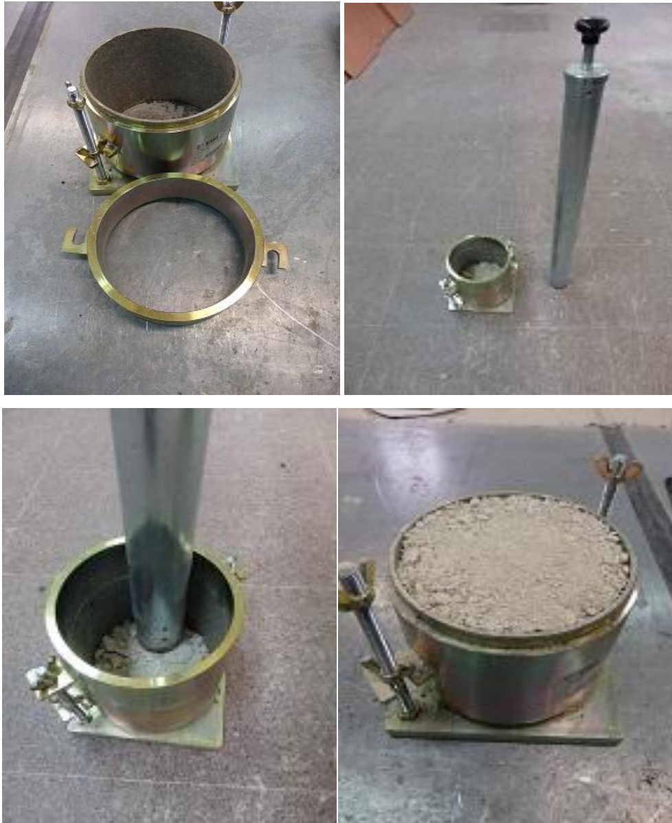
ΦΩΤΟΓΡΑΦΙΑ 4: Ειδική μήτρα δοκιμής συμπίκνωσης κατά Proctor, κόπανος και συμπίκνωση του υλικού σε στρώσεις.
