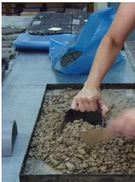
ΦΩΤΟΓΡΑΦΙΑ 6: Διαδικασία δημιουργίας μειγμάτων υλικών για την τριαξονική δοκιμή στο επιθυμητό ποσοστό υγρασίας.
