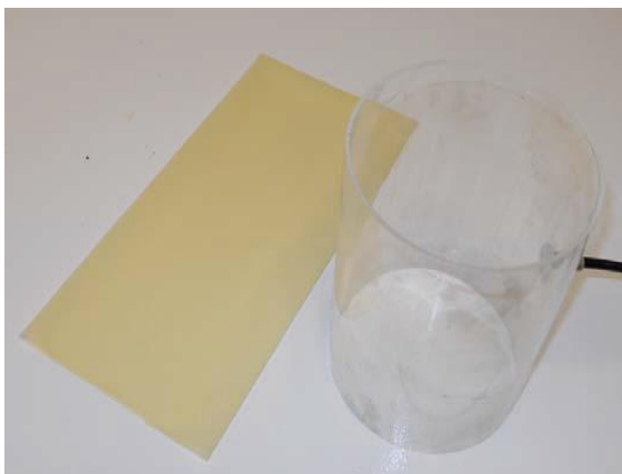
ΦΩΤΟΓΡΑΦΙΑ 7: Μembrάνη καλουπιού και πορώδης δίσκος.
