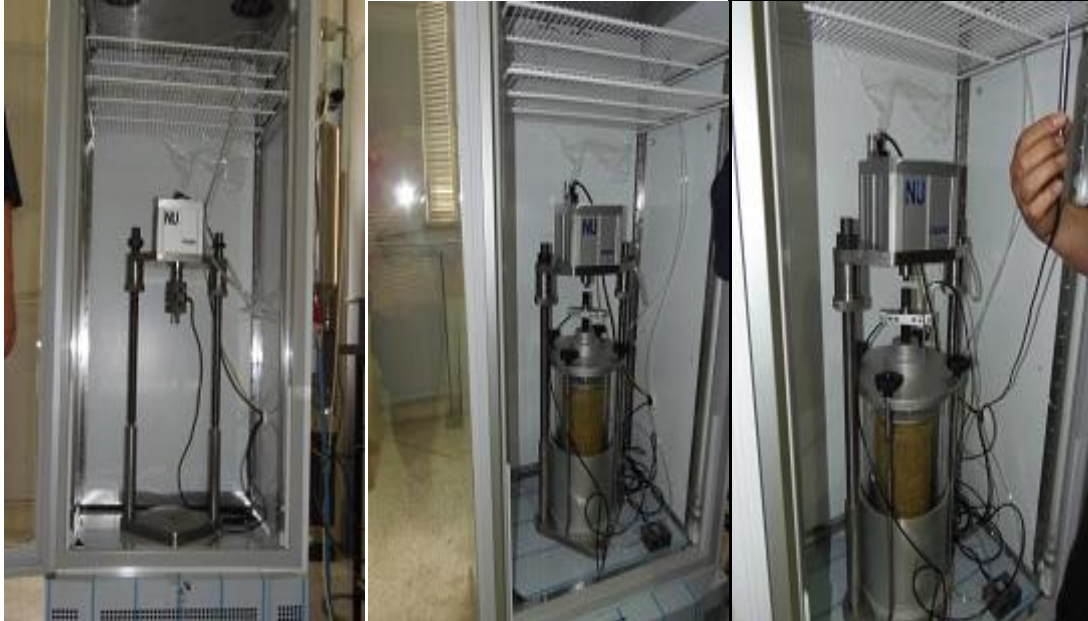
ΦΩΤΟΓΡΑΦΙΑ 11: Συσκευή τριαξονικής δοκιμής πριν και μετά την τελική τοποθέτηση του δοκιμίου και τοποθέτηση μηχανοσιομέτρου.
