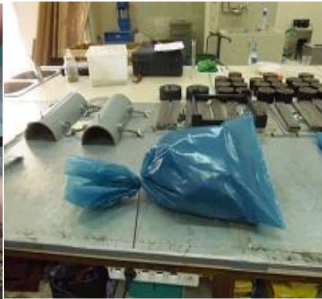
ΦΩΤΟΓΡΑΦΙΑ 6: Διαδικασία δημιουργίας μειγμάτων υλικών για την τριαξονική δοκιμή στο επιθυμητό ποσοστό υγρασίας.
