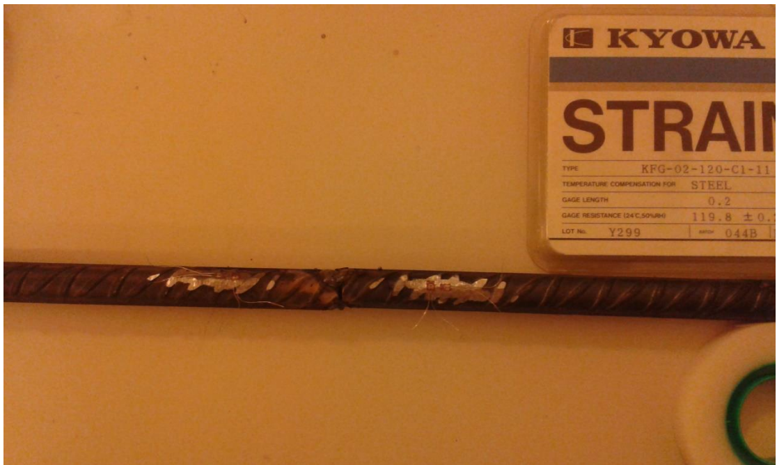
5.5 Ηλεκτρικοί μετρητές παραμόρφωσης, κολλητική ταινία και δοκίμιο
