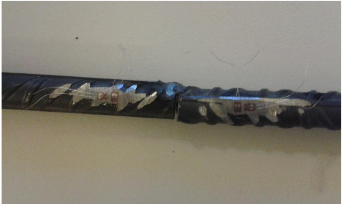
5.4 Ηλεκτρικοί μετρητές παραμόρφωσης επικολλημένοι σε δοκίμιο
