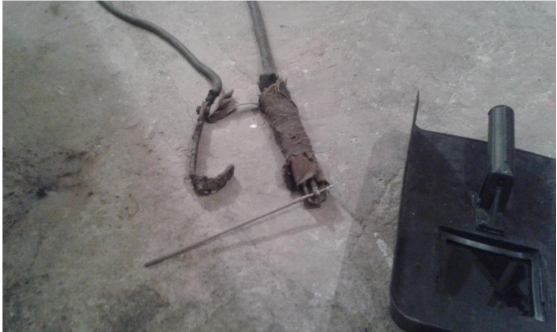
5.9 Ηλεκτροσυγκόλληση τόξου και μάσκα προστασίας
