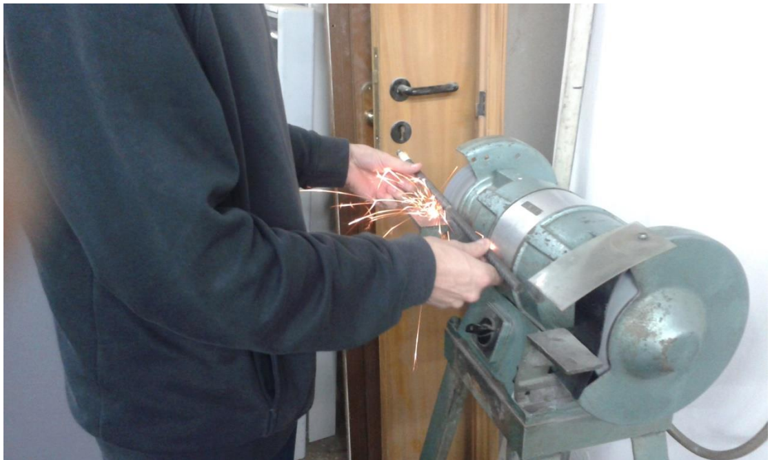
5.8 Επιφανειακή λείανση με σμυριδοτροχό
