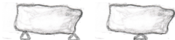
Εικόνα 12 Λανθασμένη στήριξη λιθοσωμάτων
