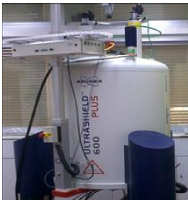
Σχήμα 4.1: Φασματόμετρο NMR 600 MHz για τη λήψη των φασμάτων
