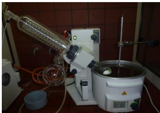
Σχήμα 5.2: περιστροφικός εξατμιστήρας (Rotavapor R-210, Buchi)
