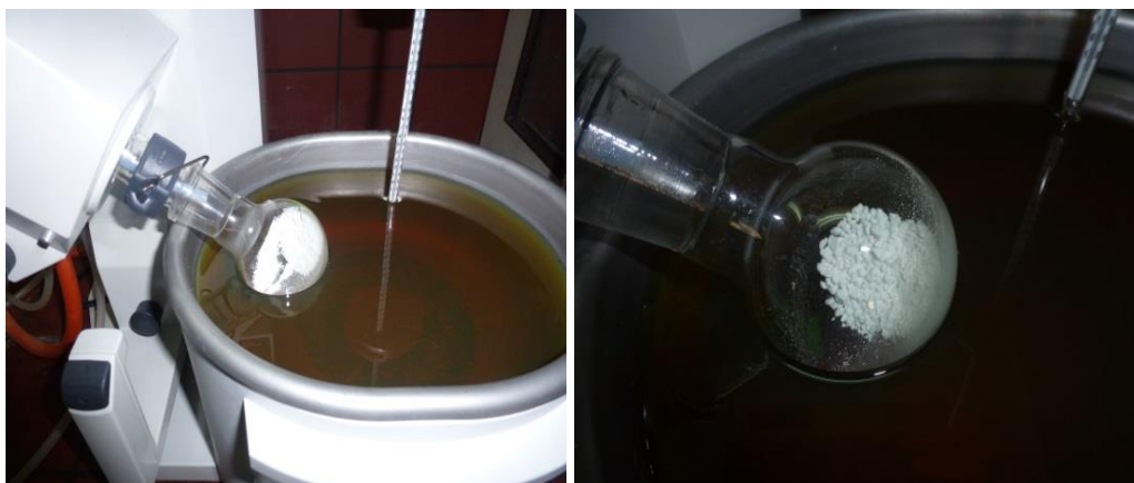
Σχήμα 6.3: διεργασία μεταπολυμερισμού του PBS
