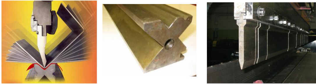
Σχήμα 1.5 Μορφοποίηση μέσω συμπίεσης
