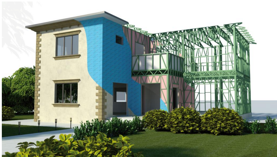
Σχήμα 1.16 Επικάλυψη μεταλλικών στοιχείων με μονωτικό υλικό σε οικία
