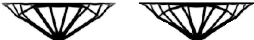
Σχ. 4.8 : Σύγκριση αποτελεσμάτων ανάλυσης κωδίκων SIMP 99(αριστερά) και SIMP88 (δεξιά) του Model_C για ίδιο volfrac = 0.3.
