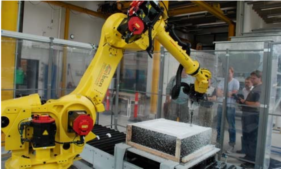
Σχ. 2.14 : Ρομποτικοί βραχίονες παρασκευής ξυλοτύπου
