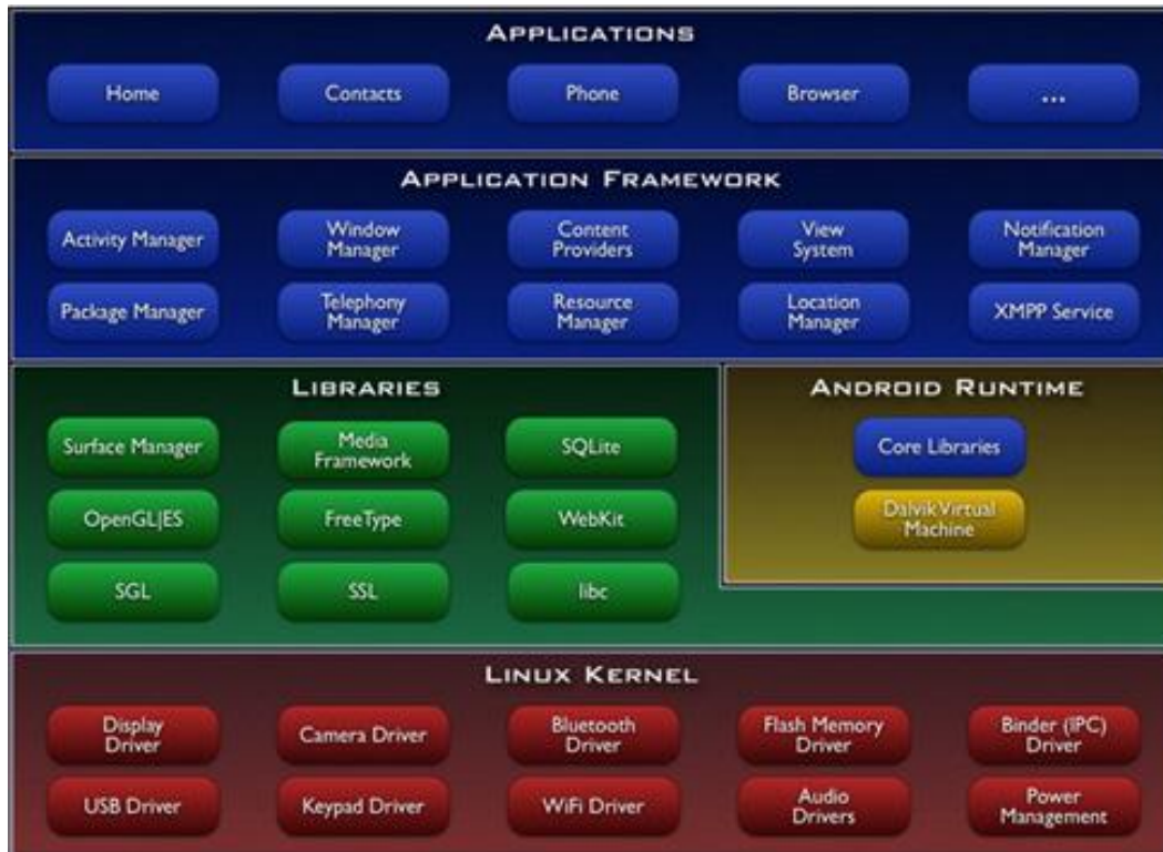
Εικόνα 5.7 Γραφική απεικόνιση των επιπέδων πλαισίου εφαρμογών του λειτουργικού συστήματος Android.
