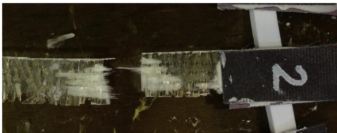
Σχήμα 3.53: Δοκίμιο TT2 μετά την αστοχία
