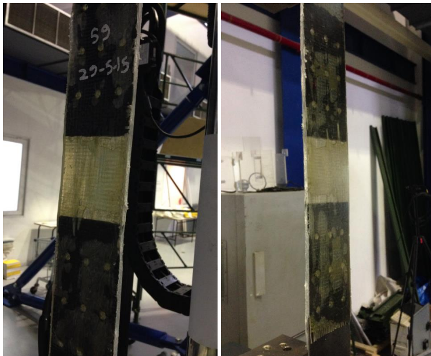
Σχήμα 3.43: Οι δύο όψεις του δοκιμίου S9 πριν την αστοχία
