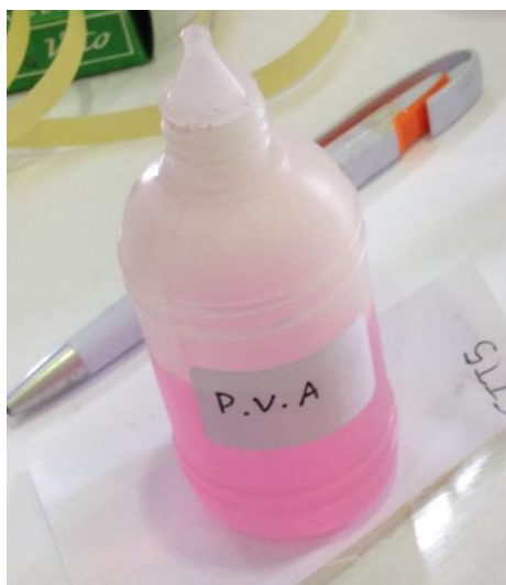
Σχήμα 3.8: Αποκολλητικό υγρό PVA
