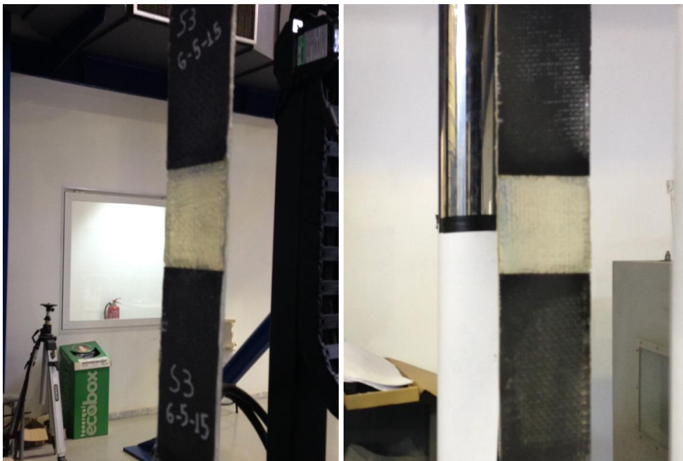
Σχήμα 3.25: Οι δύο όψεις του δοκιμίου S3 πριν την αστοχία
