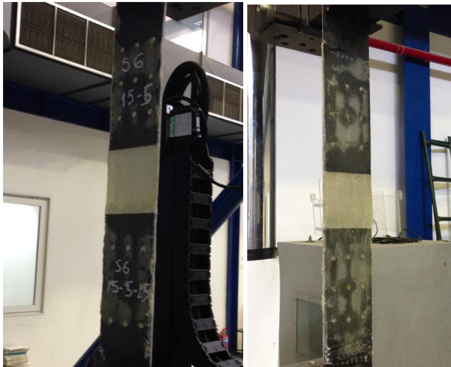
Σχήμα 3.34: Οι δύο όψεις του δοκιμίου S6 πριν την αστοχία
