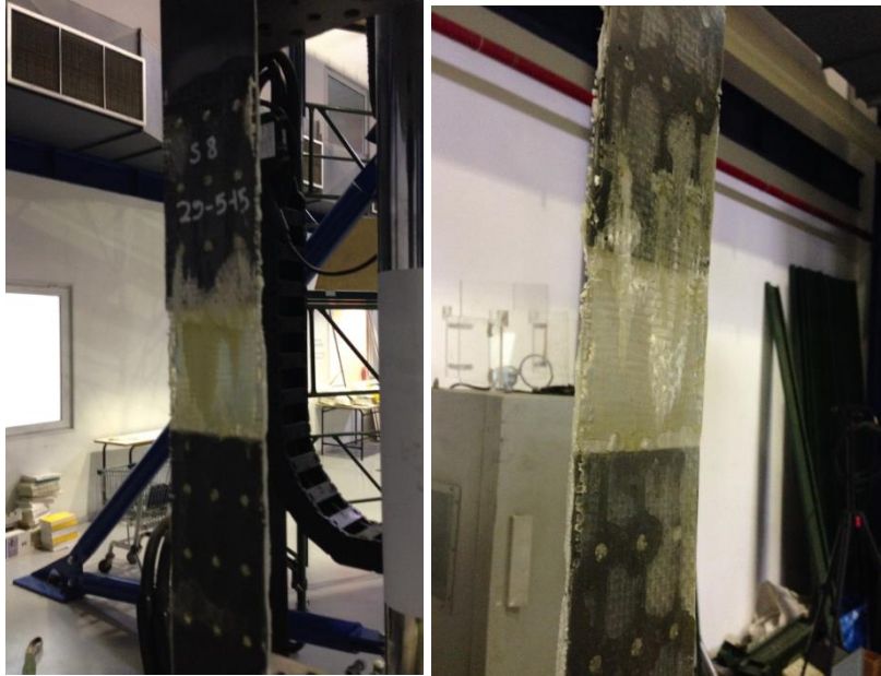
Σχήμα 3.42: Οι δύο όψεις του δοκιμίου S8 μετά την αστοχία
