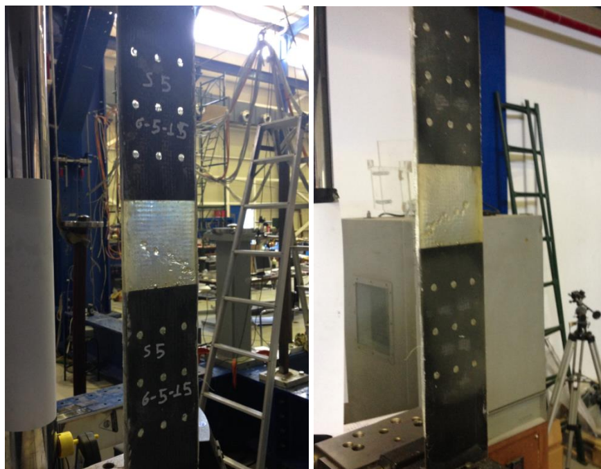
Σχήμα 3.31: Οι δύο όψεις του δοκιμίου S5 πριν την αστοχία
