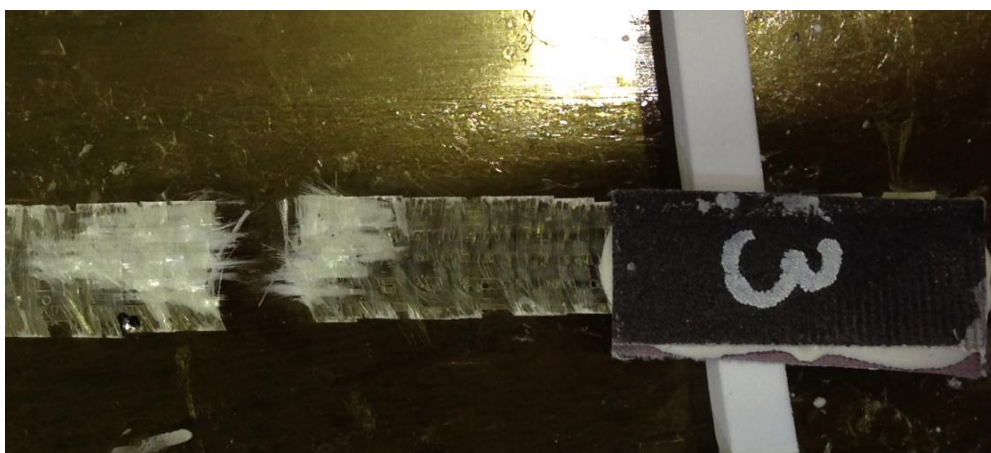
Σχήμα 3.55: Δοκίμιο TT3 μετά την αστοχία
