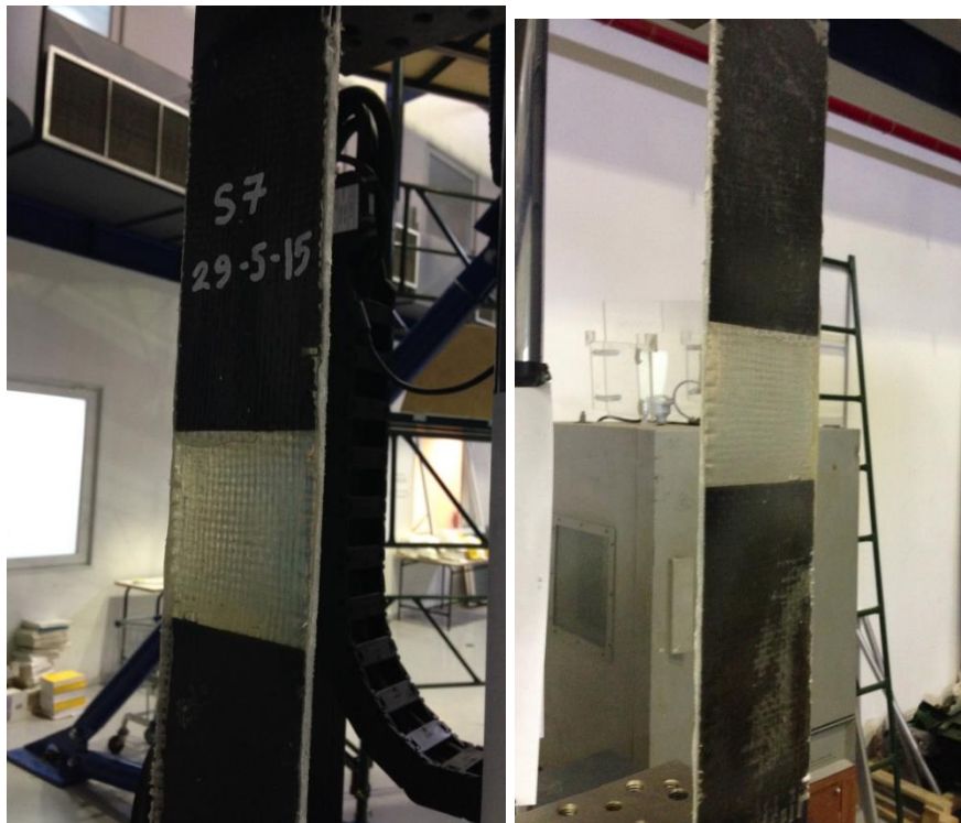
Σχήμα 3.37: Οι δύο όψεις του δοκιμίου S7 πριν την αστοχία
