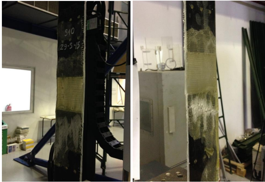
Σχήμα 3.48: Οι δύο όψεις του δοκιμίου S10 μετά την αστοχία
