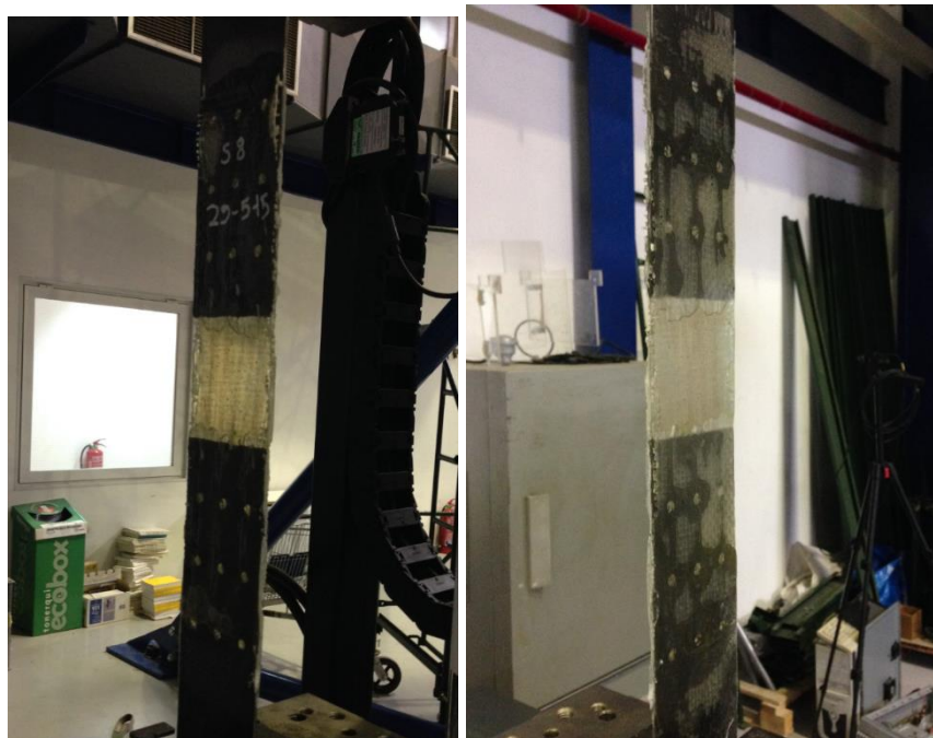
Σχήμα 3.40: Οι δύο όψεις του δοκιμίου S8 πριν την αστοχία
