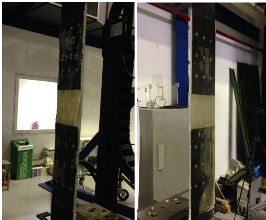
Σχήμα 3.46: Οι δύο όψεις του δοκιμίου S10 πριν την αστοχία
