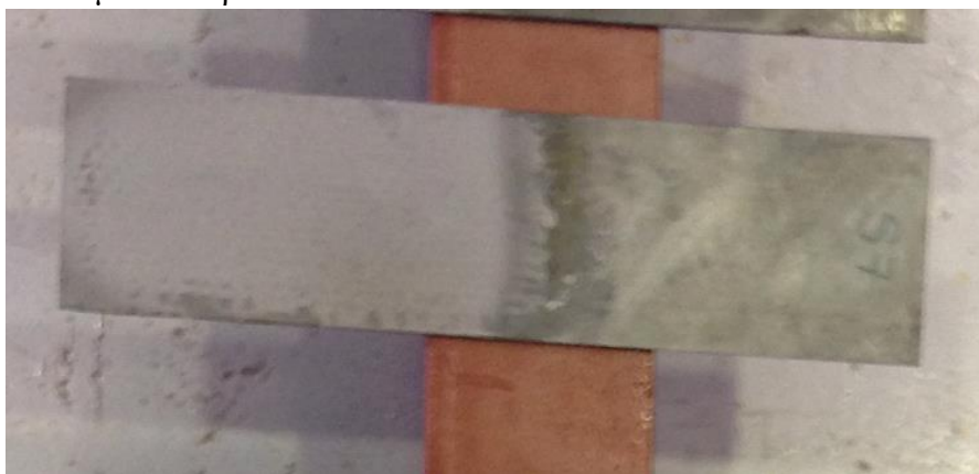
Σχήμα 3.12: Όψη αμμοβολισμένου ελάσματος (αριστερό τμήμα)
