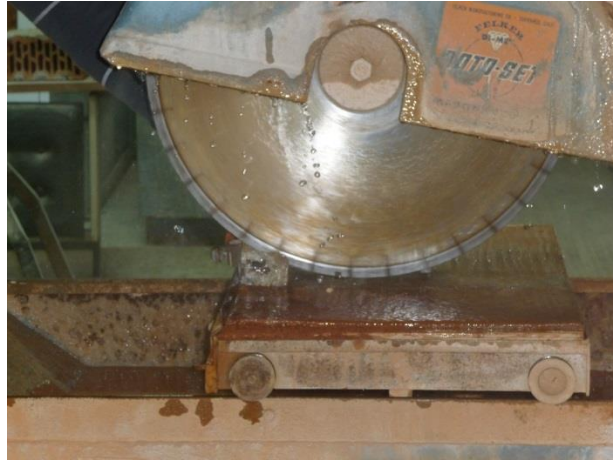
Σχ. 5.2.2 Το λιθόσωμα Λ1 κατά τη διαδικασία κοπής στον τροχό
