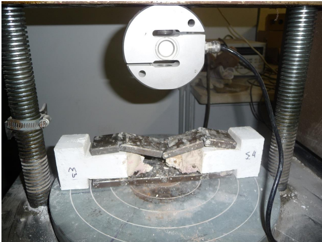
Σχ. 5.3.1 Μηχάνημα επιβολής εφελκυστικής δύναμης στο δοκίμιο
