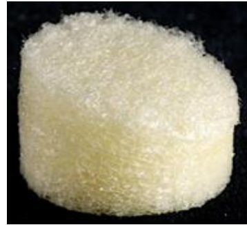
Εικόνα 3: Πορώδης δομή του ικρίωματος κολλαγόνου. Το μέσο μέγεθος πόρου είναι 100 \mu\text{m} (Pek et al. 2004, Hong et al 2010)
