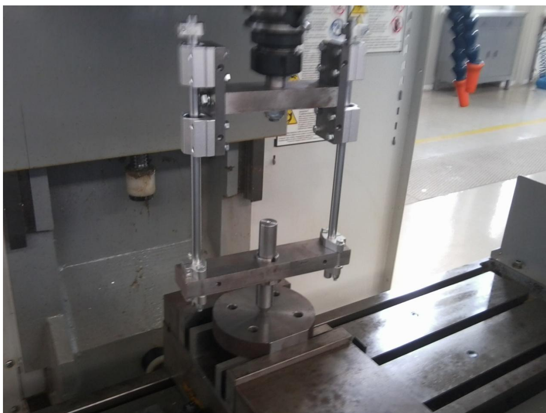
Εικόνα 4-23. Καλιμπράρισμα δεύτερης βάσης με χρήση πείρου κέντρωσης.
