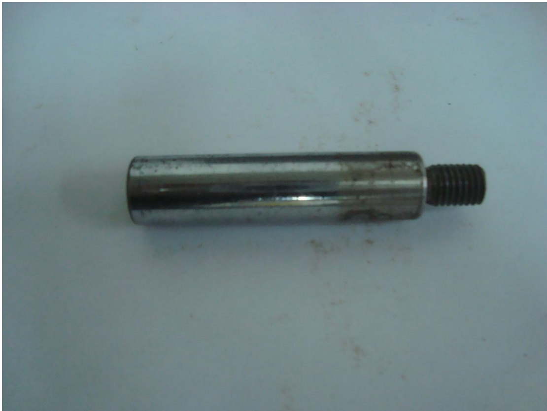
Εικόνα 4-1. Πείρος σύνδεσης, κατασκευάστηκε στον τόρνο του εργαστηρίου του κτηρίου κατεργασιών του ΕΜΠ.
