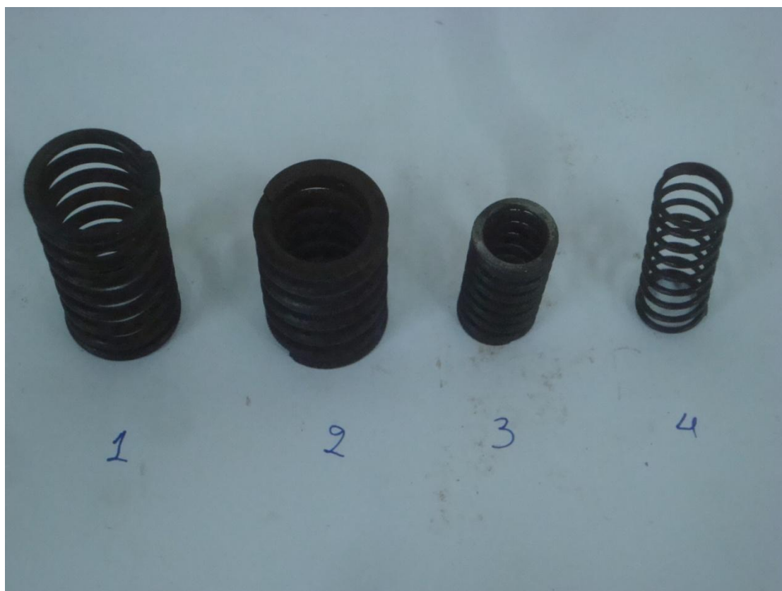
Εικόνα 4-20. Ελατήρια διαφορετικής σταθεράς διαθέσιμα προς πρόσδεση στη διάταξη της βάσης.
