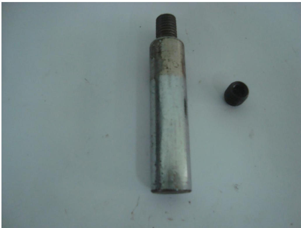
Εικόνα 4-5. Πείρος σύνδεσης (αριστερά) και κοχλίας Allen M10x1.5 L=10 χωρίς κεφαλή (δεξιά).
