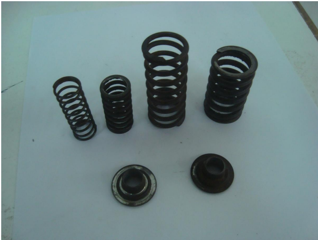
Εικόνα 4-15. Ελατήρια διαφορετικής σταθεράς K και βάσεις συγκράτησης ελατηρίων.
