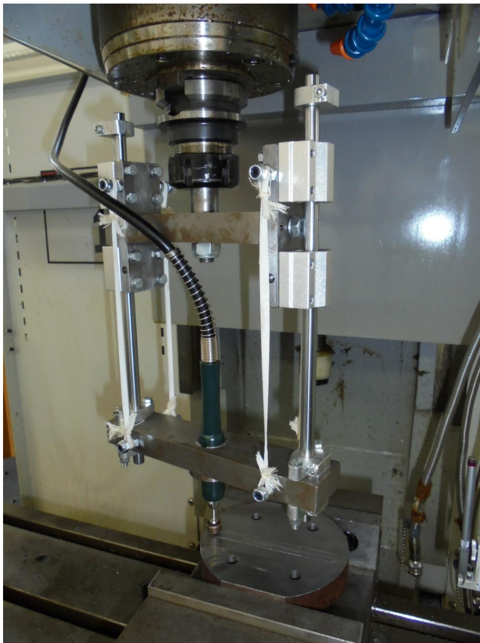
Εικόνα 6-5. Πειραματική διάταξη αυτοματοποιημένης στίλβωσης (2 η βάση, εκχόνδριση με διαμαντένιο δακτύλιο).
