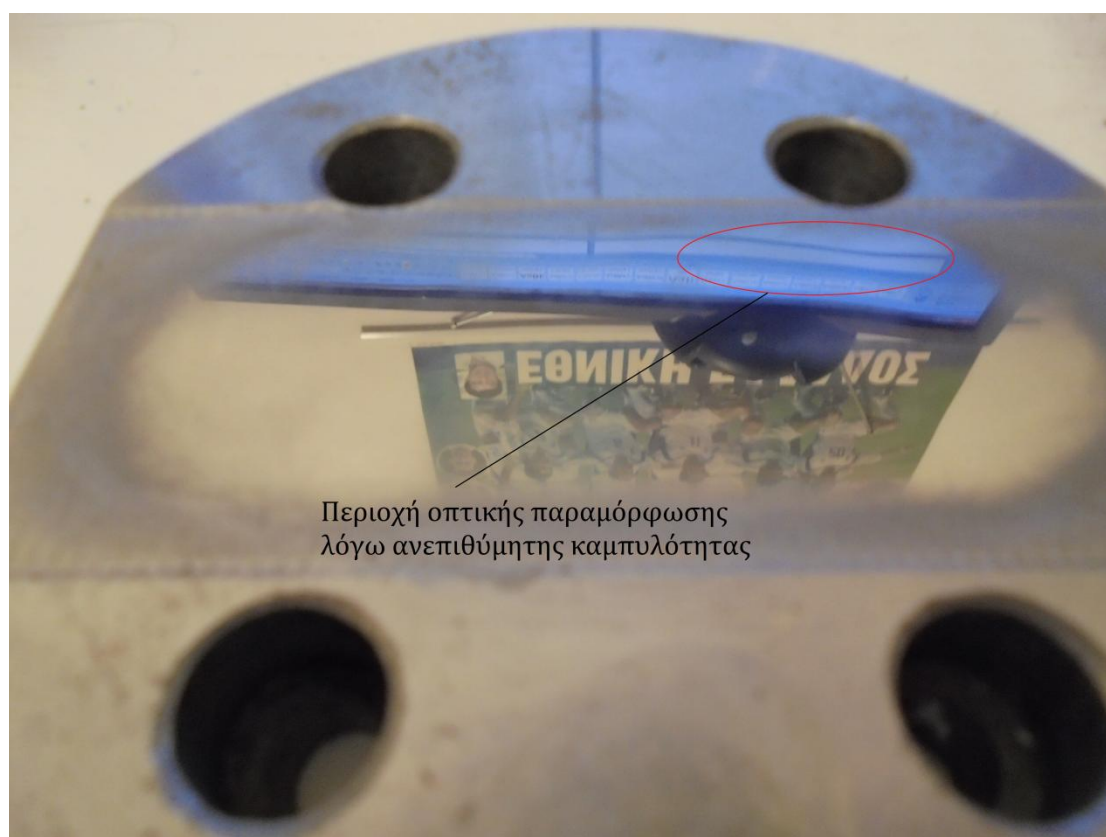
Εικόνα 6-3. Οπτική παραμόρφωση καθρεπτιζόμενου ειδώλου λόγω ανεπιθύμητης καμπυλότητας.
