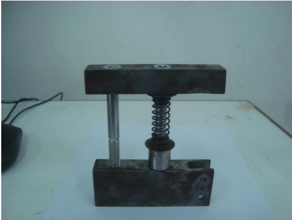
Εικόνα 4-18. Συναρμολογημένη διάταξη βάσης (έχει αποσυνδεθεί η άκρη του grinder) σε ελευθερία.
