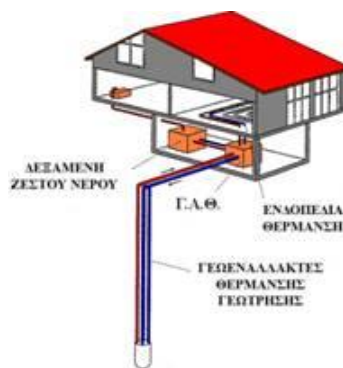
Εικόνα 6.6 : Κύρια μέρη συστήματος ΓΑΘ
