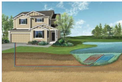
Εικόνα 6.8 : Γεωθερμικοί Εναλλάκτες Ανοικτού Κυκλώματος
