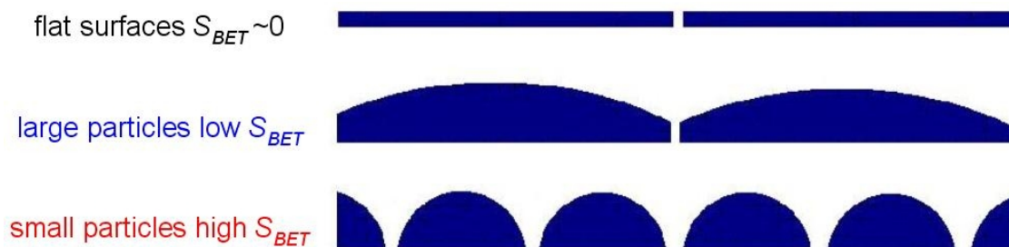
Εικόνα 13. Σχηματική εκτίμηση της επιφανειακής τραχύτητας - πορωσιμότητας στην επιφάνεια συσσωματωμάτων που απαρτίζονται από σωματίδια σφαιρικού σχήματος.
