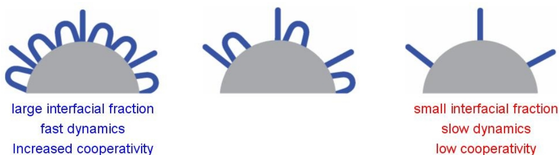
Εικόνα 23. Απλοποιημένο μοντέλο πολλαπλών διαμορφώσεων των πολυμερικών αλυσίδων προσροφημένων σε στερεή ελκτική επιφάνεια
