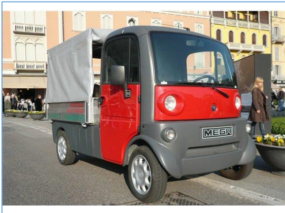
Εικόνα 2-14 Όχημα κατηγορίας L6e-BU – Ελαφρό τετράτροχο μικροαυτοκίνητο για τη μεταφορά εμπορευμάτων
