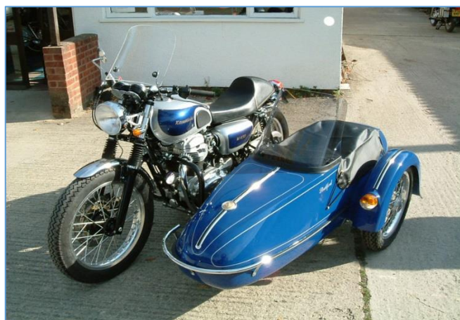
Εικόνα 2-10 Όχημα κατηγορίας L4e – Δίκυκλη μοτοσικλέτα με καλάθι Watsonian Stratford
