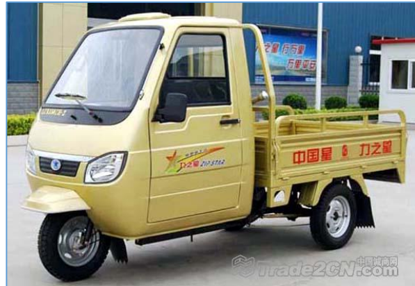
Εικόνα 2-12 Όχημα κατηγορίας L5e-B – Εμπορικό τρίκυκλο
