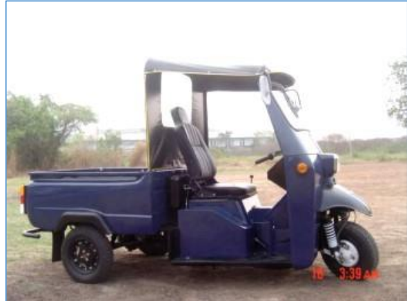
Εικόνα 2-4 Όχημα κατηγορίας L2e-U – Τρίκυκλο μοτοποδήλατο για επαγγελματική χρήση
