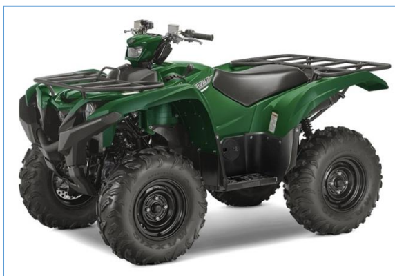
Εικόνα 2-17 Όχημα κατηγορίας L7e-B1 – βαριά τετράτροχη μοτοσικλέτα παντός εδάφους YAMAHA GRIZZLY EPS
