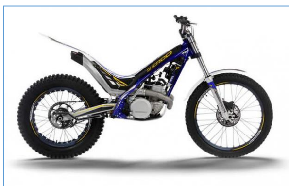
Εικόνα 2-9 Όχημα κατηγορίας L3e-AxT – Μοτοσικλέτα τύπου Trial Sherco 2015 ST250
