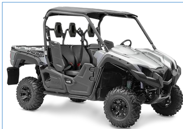
Εικόνα 2-18 Όχημα κατηγορίας L7e-B2 – όχημα υπαίθριων δραστηριοτήτων YAMAHA VIKING EPS SE
