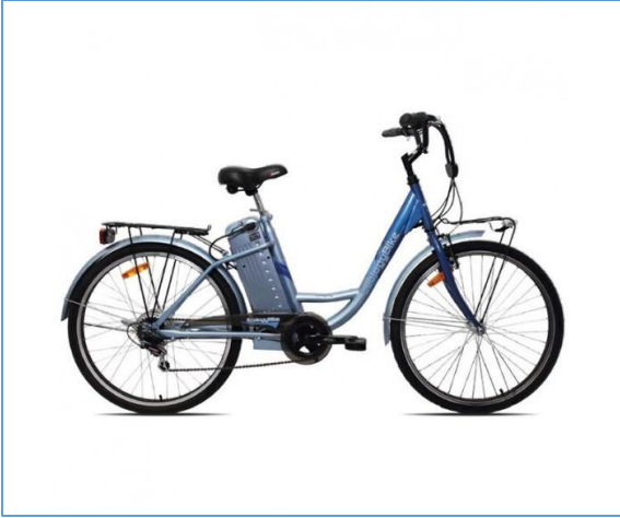
Εικόνα 2-1 Όχημα κατηγορίας L1e-A – Ηλεκτρικό ποδήλατο ESPERIA 91000
