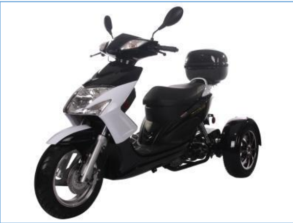
Εικόνα 2-3 Όχημα κατηγορίας L2e-P – Τρίκυκλο μοτοποδήλατο Elite 50cc Trike
