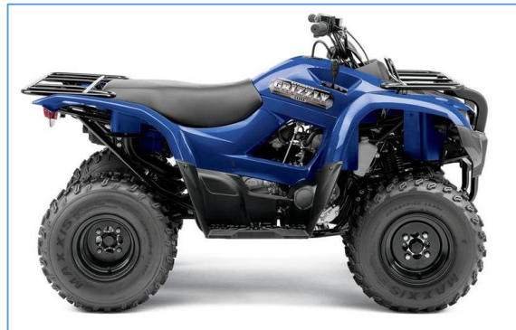
Εικόνα 2-13 Όχημα κατηγορίας L6e-A – Ελαφριά τετράτροχη μοτοσικλέτα YAMAHA GRIZZLY 300
