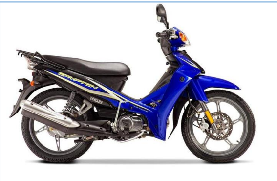
Εικόνα 2-5 Όχημα κατηγορίας L3e-A1 – Δίκυκλη μοτοσικλέτα χαμηλής επίδοσης YAMAHA CRYPTON 110
