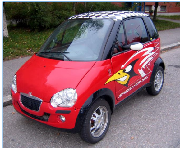
Εικόνα 2-15 Όχημα κατηγορίας L6e-BP – Ελαφρό τετράτροχο μικροαυτοκίνητο για τη μεταφορά επιβατών GrecaV EKE
