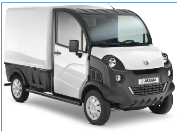
Εικόνα 2-19 Όχημα κατηγορίας L7e-CU – βαρύ τετράτροχο όχημα επαγγελματικής χρήσης AIXAM D-TRUCK
