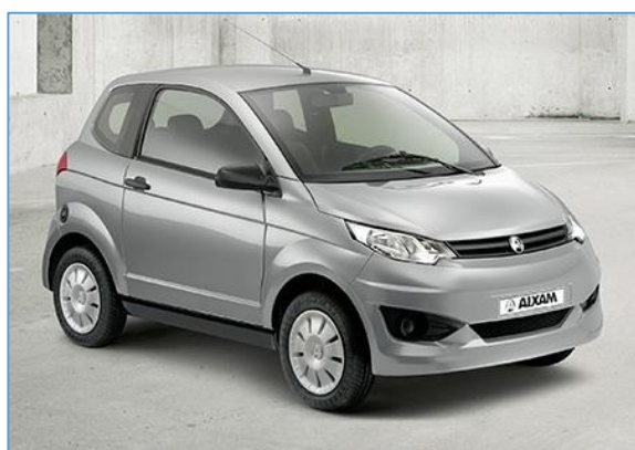
Εικόνα 2-20 Όχημα κατηγορίας L7e-CP – βαρύ τετράτροχο επιβατικό όχημα AIXAM City PACK
