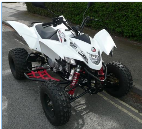
Εικόνα 2-16 Όχημα κατηγορίας L7e-Ax – Βαριά τετράτροχη μοτοσικλέτα για χρήση εντός δρόμου QYADZILLA XLC500
