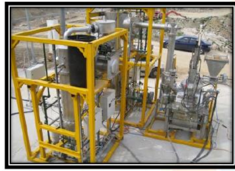
Εικόνα 28: Φωτογραφίες της πιλοτικής μονάδας αεριοποίησης/ υαλοποίησης στην Ελλάδα[108]
