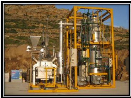
Εικόνα 28: Φωτογραφίες της πιλοτικής μονάδας αεριοποίησης/ υαλοποίησης στην Ελλάδα[108]
