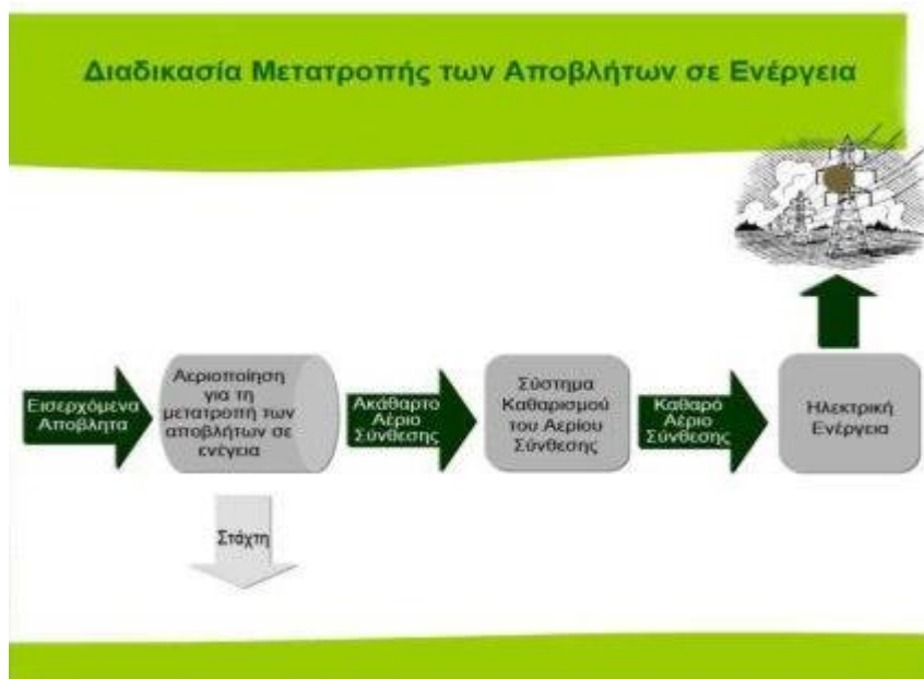
Διάγραμμα 22: Διαδικασία μετατροπής των αποβλήτων σε ενέργεια(με αεριοποίηση)[107]
