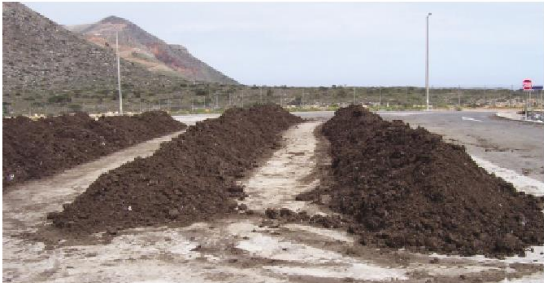
Εικόνα 12: Σειράδια ωρίμανσης Compost στο εργοστάσιο αερόβιας Μηχανικής Βιολογικής Επεξεργασίας Χανίων[12]
