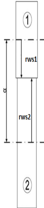
Εικόνα 2.9: Απόσταση αξόνων τροχών σε βαθμίδα οδοντωτών τροχών εξωτερικής οδόντωσης
