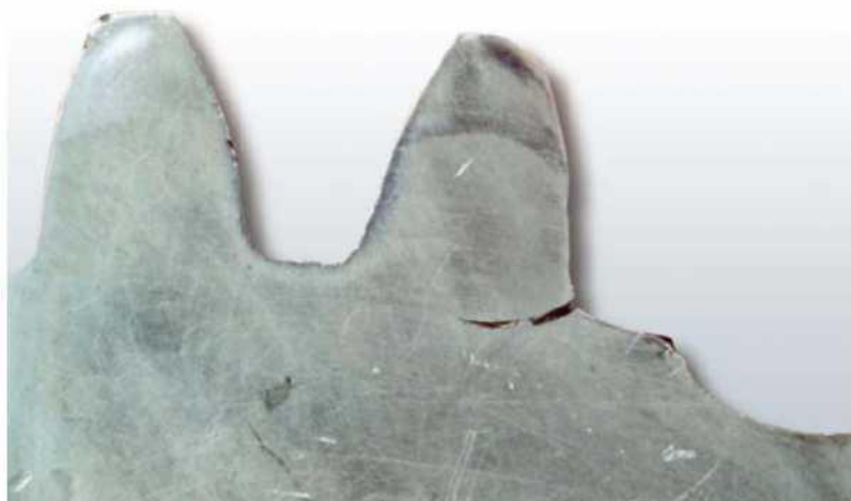
Εικόνα 3.2: Σπασμένος οδόντας στα δεξιά και έναρξη ρωγμής στα αριστερά της Εικόνας.
