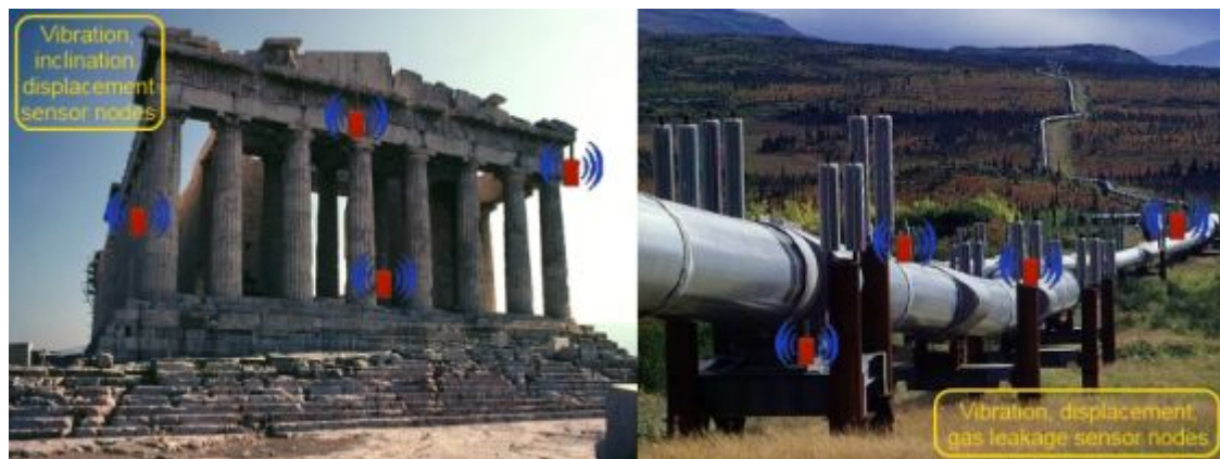
Σχήμα.4 – εφαρμογές παλμικών αισθητήρων για την παρακολούθηση της υγείας κατασκευών
