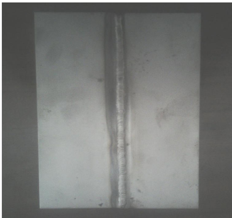
Εικόνα 5.2: Το συγκολλημένο δοκίμιο St 37-2 με συγκόλληση TIG
