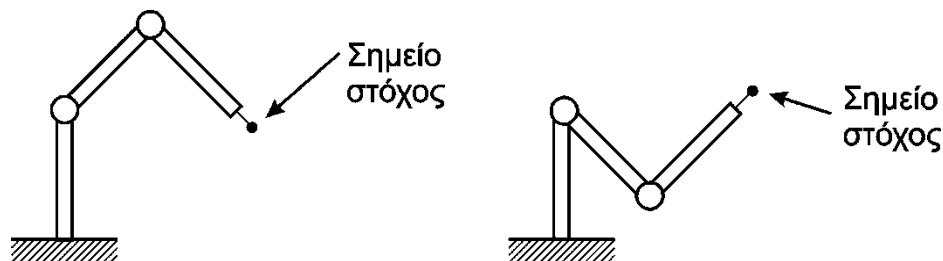
ΣΧΗΜΑ 2.20 Δύο διαφορετικές διαμορφώσεις του άξονα με τον end effector τοποθετημένο στο ίδιο σημείο.
