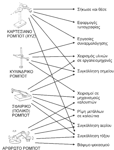
ΣΧΗΜΑ 2.8 Χρήση των καρτεσιανών, κυλινδρικών, σφαιρικών και αρθρωτών ρομπότ στις διάφορες βιομηχανικές εφαρμογές.
