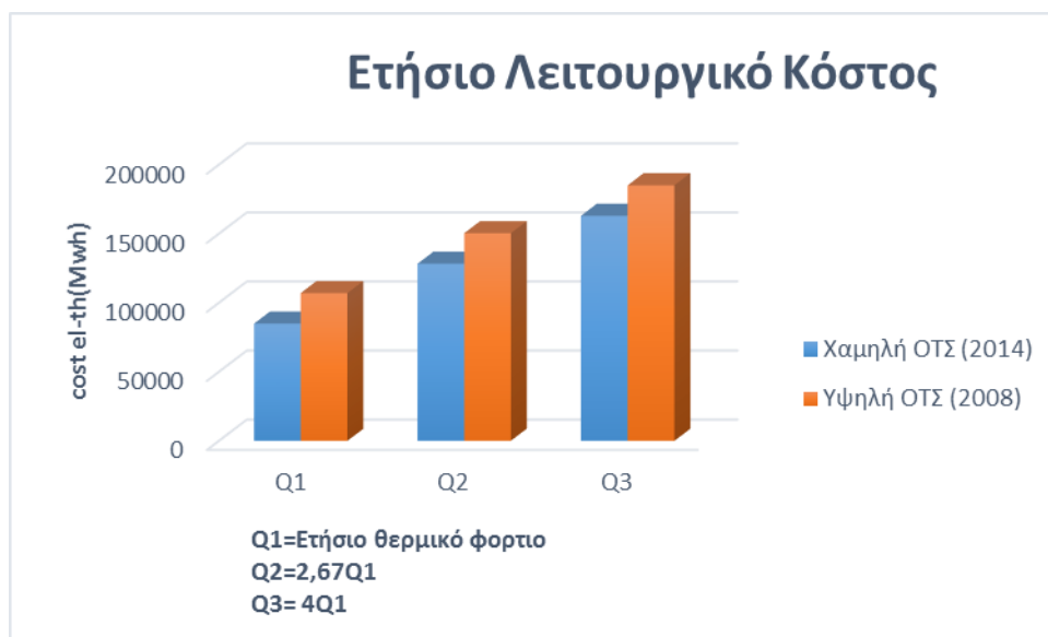
Γράφημα 6.65: Το ετήσιο λειτουργικό κόστος του 1 ου Σεναρίου με κόστος εκπομπών 0.5€/tn .
