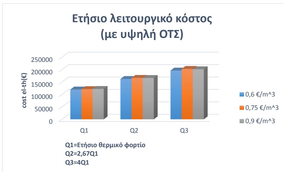
Γράφημα 6.35: Συνολικό λειτουργικό κόστος στο Σενάριο 4 για τα τρία ετήσια θερμικά φορτία και τις τρεις τιμές κόστους φυσικού αερίου με οριακή τιμή συστήματος του 2008. Στην περίπτωση όπου η ενεργειακοί διανομείς λειτουργούν με τρόπο local-optimization .
