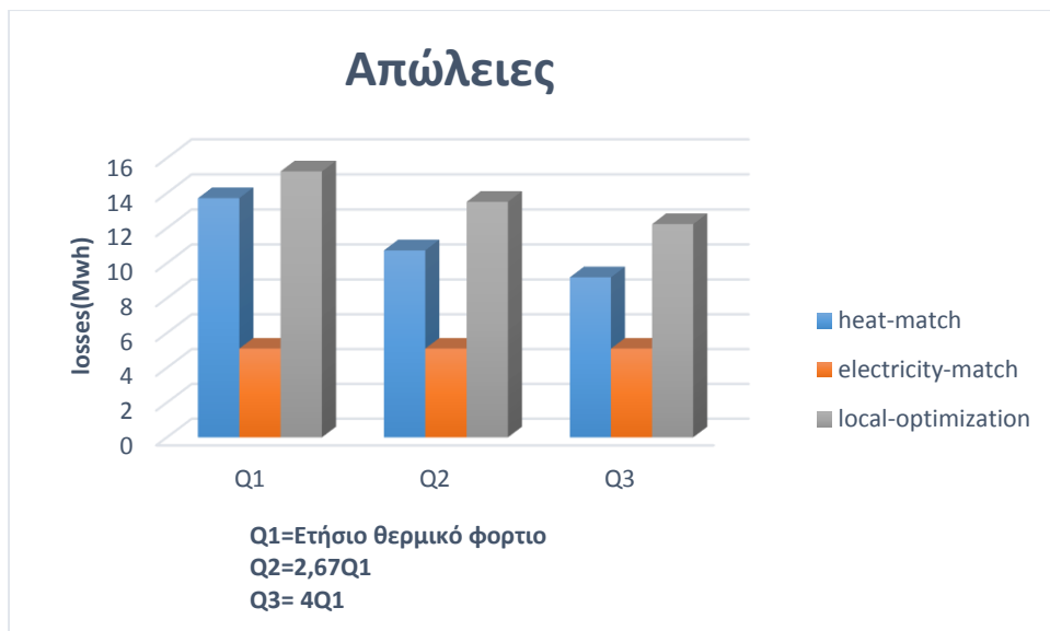
Γράφημα 6.37: οι συνολικές απώλειες του 4 ου Σεναρίου για τα τρία θερμικά φορτία και για τους τρεις τρόπους λειτουργίας των ενεργειακών διανομών
