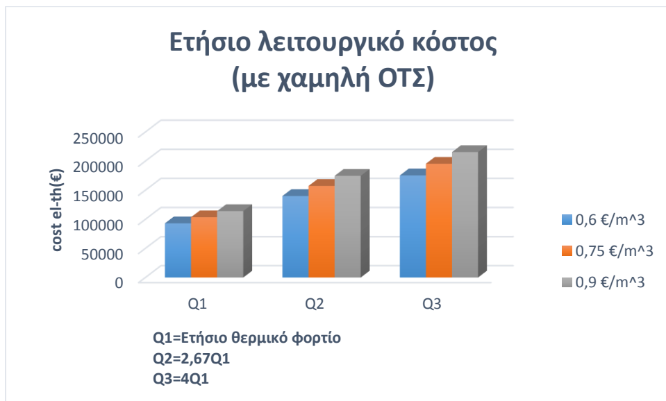
Γράφημα 6.51: Συνολικό λειτουργικό κόστος στο Σενάριο 5 για τα τρία ετήσια θερμικά φορτία και τις τρεις τιμές κόστους φυσικού αερίου με οριακή τιμή συστήματος του 2014. Στην περίπτωση όπου η ενεργειακοί διανομείς λειτουργούν με τρόπο heat-match.
