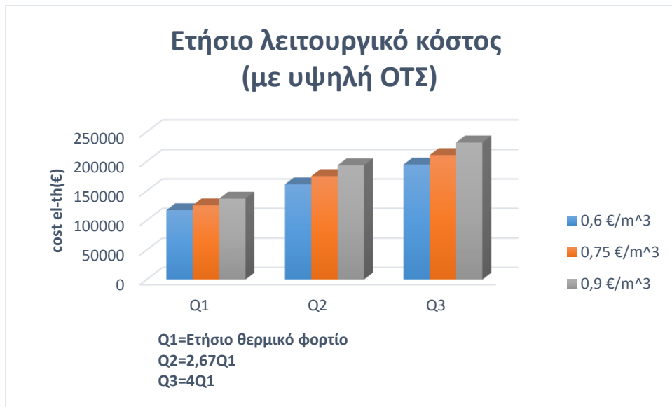
Γράφημα 6.50: Συνολικό λειτουργικό κόστος στο Σενάριο 5 για τα τρία ετήσια θερμικά φορτία και τις τρεις τιμές κόστους φυσικού αερίου με οριακή τιμή συστήματος του 2008. Στην περίπτωση όπου η ενεργειακοί διανομείς λειτουργούν με τρόπο heat-match.
