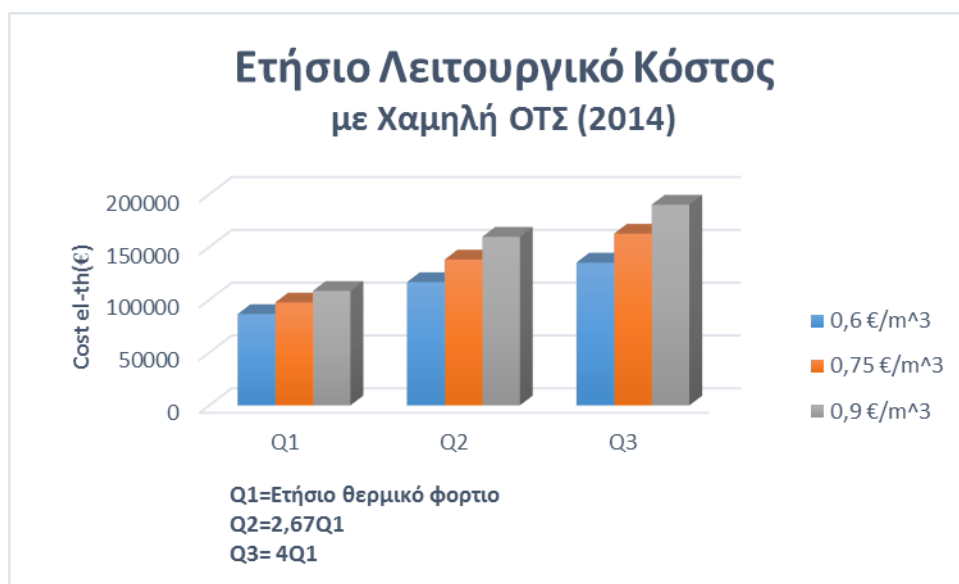
Γράφημα 6.82: Το ετήσιο λειτουργικό κόστος του 4 ου Σεναρίου με κόστος εκπομπών 0.5€/tn και με οριακή τιμή συστήματος του 2014.
