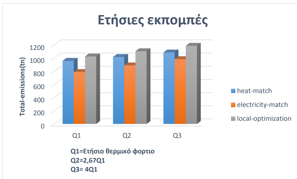
Γράφημα 6.56: Ετήσιες εκπομπές διοξειδίου του άνθρακα στο Σενάριο 5 για τα τρία ετήσια θερμικά και για τους τρεις τρόπους λειτουργίας των ενεργειακών διανομών.
