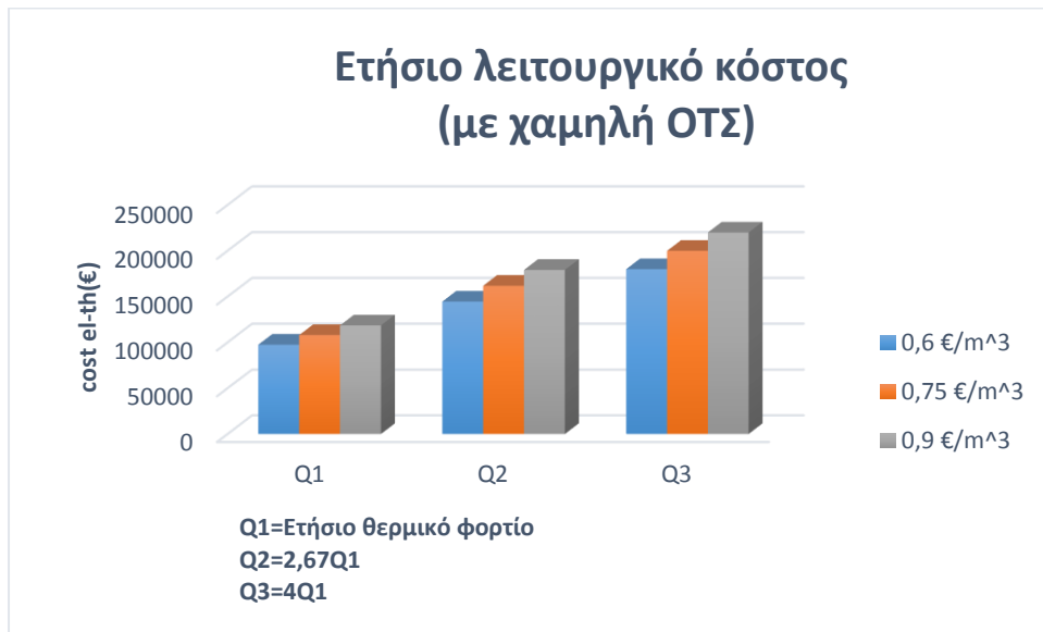
Γράφημα 6.30: Συνολικό λειτουργικό κόστος στο Σενάριο 4 για τα τρία ετήσια θερμικά φορτία και τις τρεις τιμές κόστους φυσικού αερίου με οριακή τιμή συστήματος του 2014. Στην περίπτωση όπου η ενεργειακοί διανομείς λειτουργούν με τρόπο heat-match .
