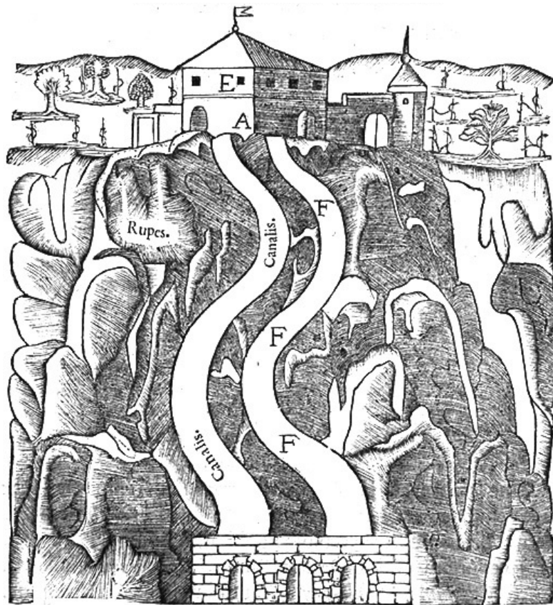
Το «Αυτί του Διονύσου» στις Συρακούσες ( Phonurgia Nova ), ο Τύραννος μπορούσε να ακούει κρυφά τους υπηκόους του χωρίς να το ξέρουν. Η αρχιτεκτονική επαναδιατυπώνει το όργανο κατασκευάζοντας μια επιθυμητική μηχανή
