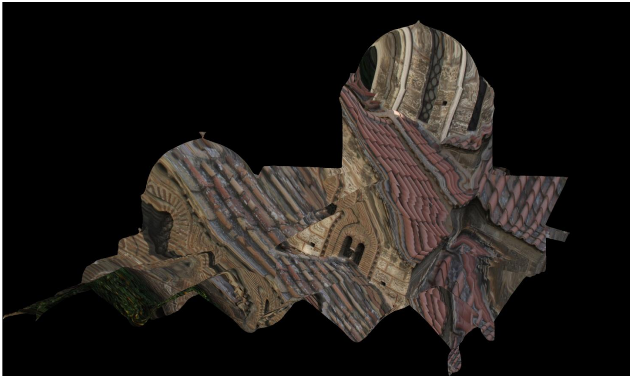
Εικόνα 47: Στιγμιότυπο από το λογισμικό Image Master, στο οποίο η απόδοση υφής στο μοντέλο είναι μη αποδεκτή
