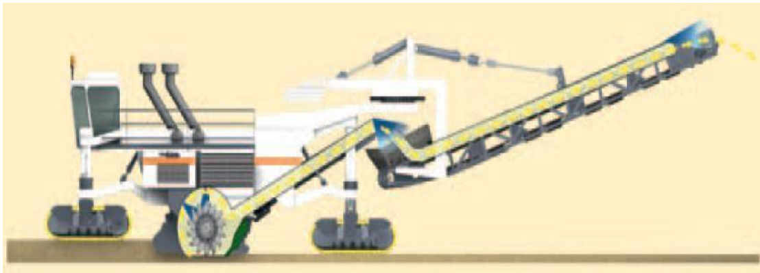
Εικόνα 3. 51. Συστήματα ψεκασμού σε ένα surface miner. Wirtgen (2010).
