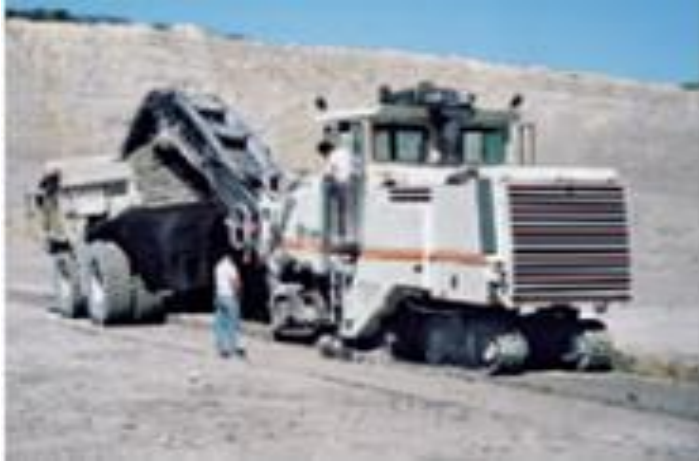
Εικόνα 3. 30. Άμεση φόρτωση φορτηγού μπροστά από το surface miner. Wirtgen (2010).
