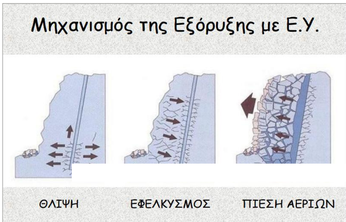
Εικόνα 2. 1. Δράση μηχανισμού εξόρυξης με εκρηκτικές ύλες. Παναγιώτου (2006).
