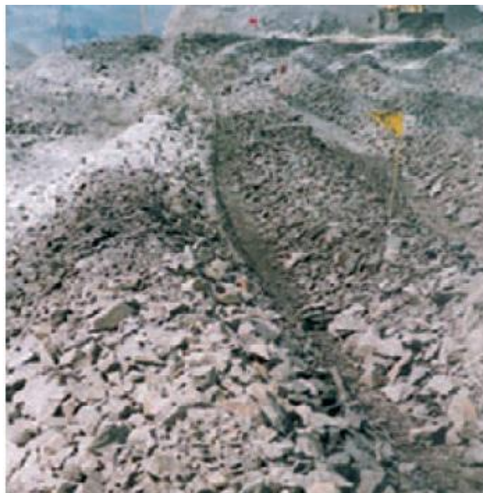
Εικόνα 3. 50. Όψη χώρου εργασίας κατά την πραγματοποίηση κοπής με κεντρική απόθεση. Wirtgen (2010).
