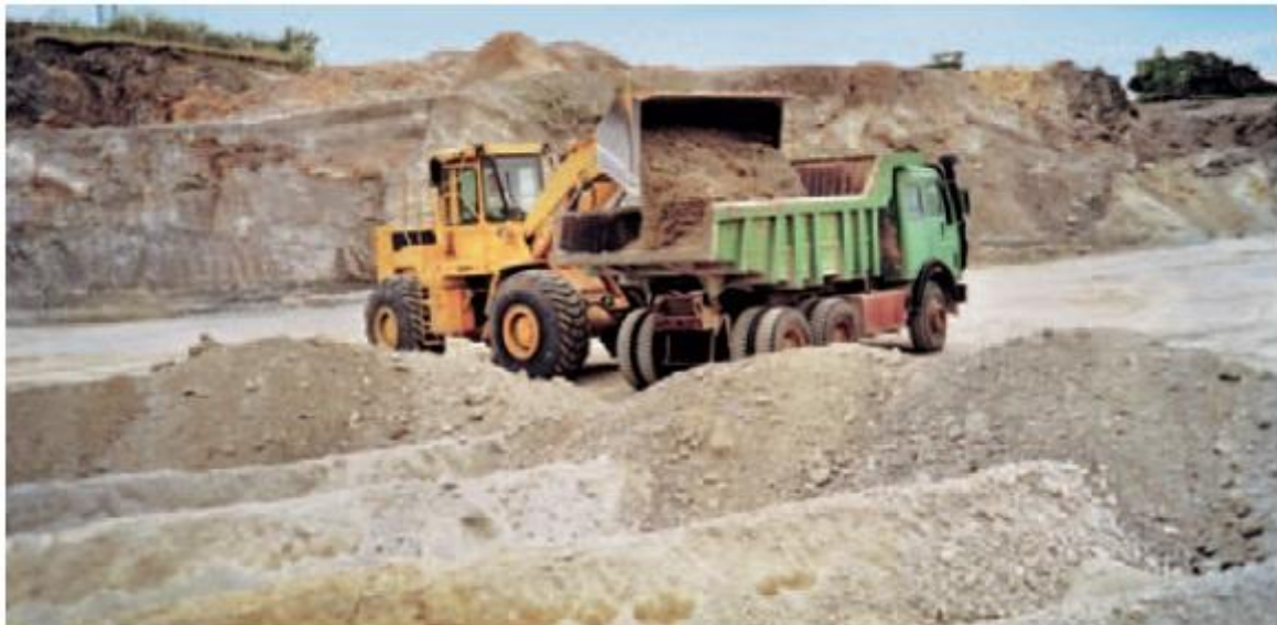
Εικόνα 3. 39. Φόρτωση σε φορτηγό με φορτωτή. Wirtgen (2010).
