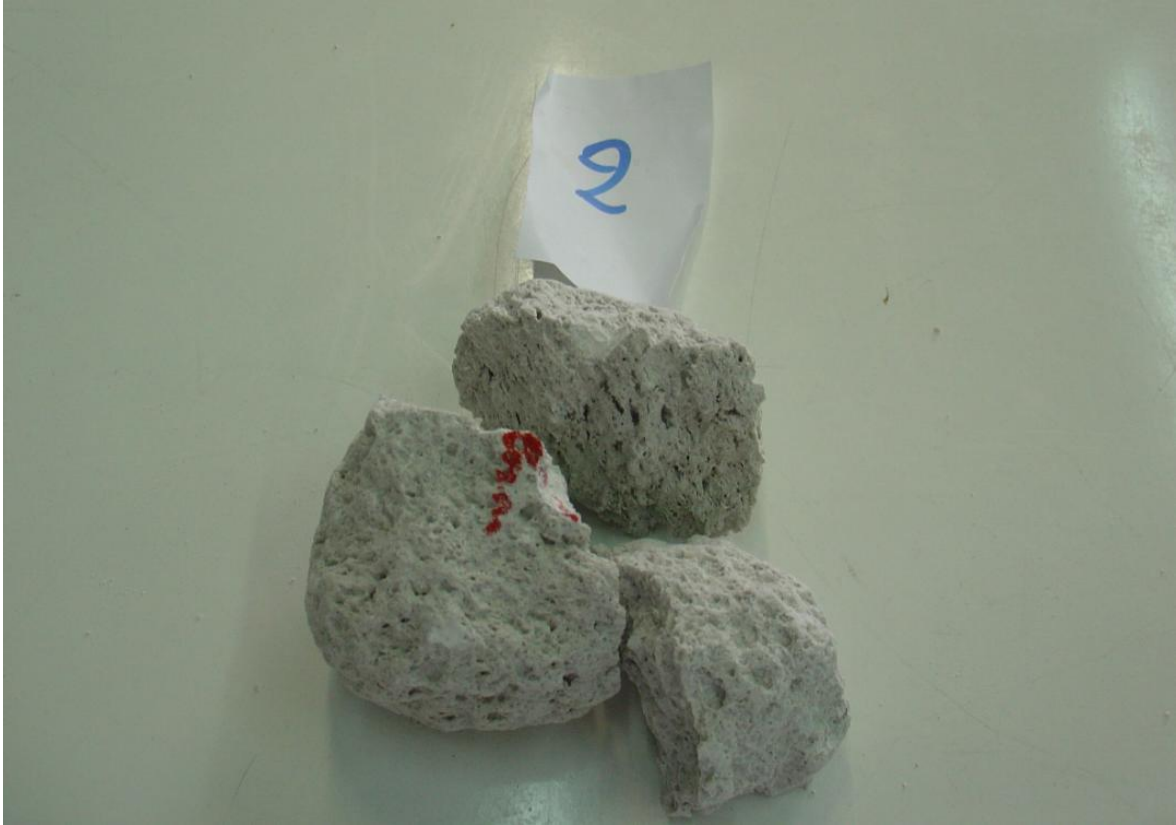
Εικόνα 4. 15. Αστοχία δοκιμίου No. 2 σε σημειακή φόρτιση.
