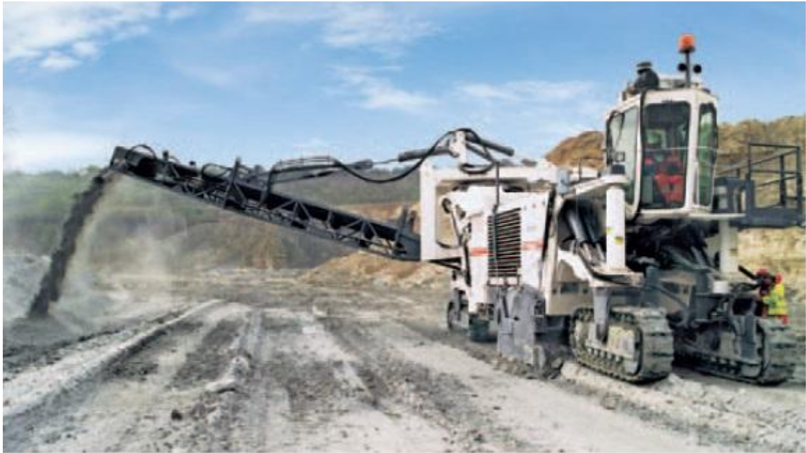
Εικόνα 3. 36. Πλευρική απόθεση υλικού σε σωρούς. Wirtgen (2010).
