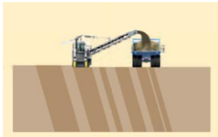
Εικόνα 3. 48. Εξόρυξη πολυστρωματικών κεκλιμένων κοιτασμάτων σχετικά μικρού πάχους. Wirtgen (2010).
