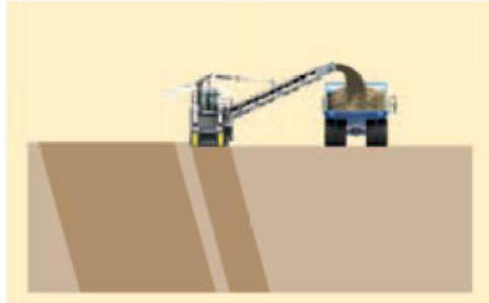
Εικόνα 3. 49. Εξόρυξη πολυστρωματικών κεκλιμένων στρωμάτων μεγάλου πάχους. Wirtgen (2010).
