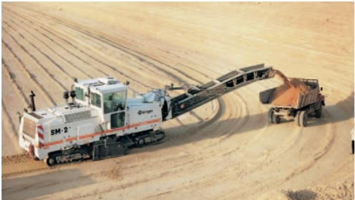
Εικόνα 3. 24. Κάθετες κοπές με εξόρυξη κατά τη στροφή. Wirtgen (2010).
