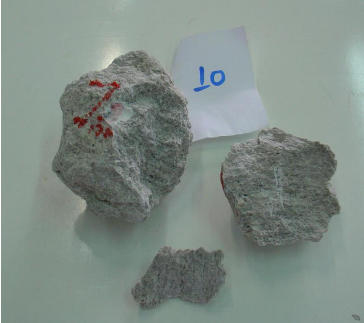
Εικόνα 4. 16. Αστοχία δοκιμίου No. 10 σε σημειακή φόρτιση.
