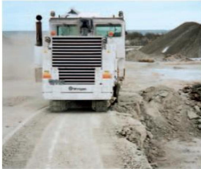
Εικόνα 3. 21. Εξόρυξη σε προϋπάρχουσες βαθμίδες. Wirtgen (2010).
