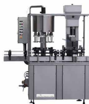
Εμφιαλωτήριο πλύσιμο και γέμισμα φιαλών
