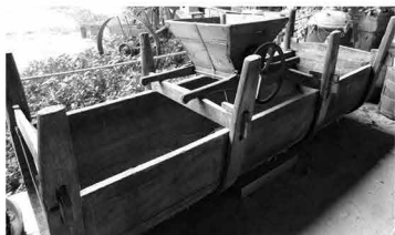
Σπαστήρας σταφυλιών διαχωρισμός στεμφύλων από τις ρώγες απομάκρυνση βλαστράγγων
