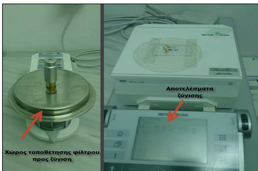
Εικόνα 6.13: Ο ζυγός MX5 στο ειδικό δωμάτιο ζύγισης
