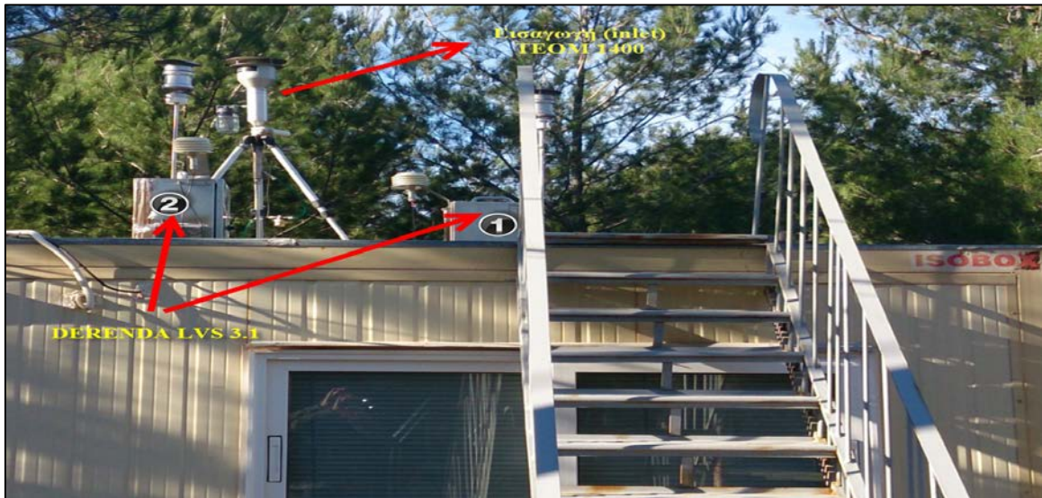
Εικόνα 6.4: ISOBOX: Στη οροφή του είναι τοποθετημένοι οι δύο δειγματολήπτες τύπου DERENDA LVS 3.1. Στον 1 ο δειγματολήπτη έγινε χρήση φίλτρων Enfab ενώ στον 2 ο χρήση φίλτρων Whatman PTFE
