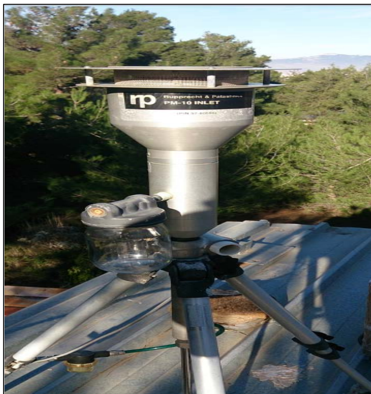
Εικόνα 6.6: Η εισαγωγή (inlet) του αέρα /σωματιδίων PM 10 στην οροφή του οικίσκου
