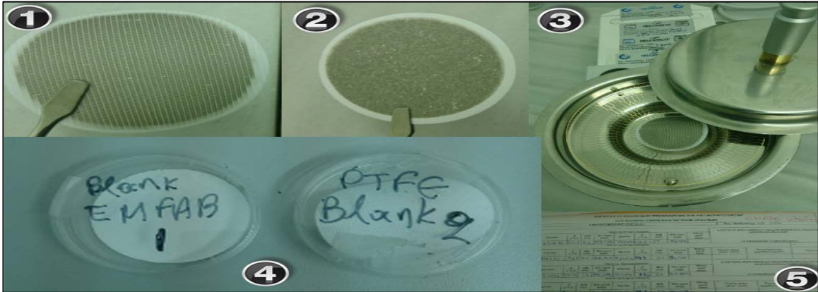
Εικόνα 6.18: (1) Φορτισμένο φίλτρο PTFE, (2) ENFAB, (3) Τοποθέτηση φίλτρου σε εσωτερικό ζυγού, (4) Μόνιμα λευκά φίλτρα (Blank) στο θαλαμο ζύγισης και (5) Έντυπο καταγραφής
